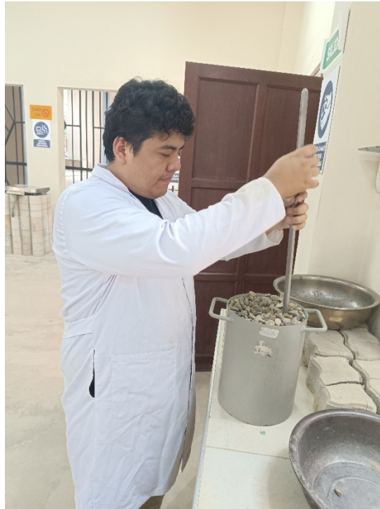
Imagen 11. Obtención del peso unitario de los agregados
