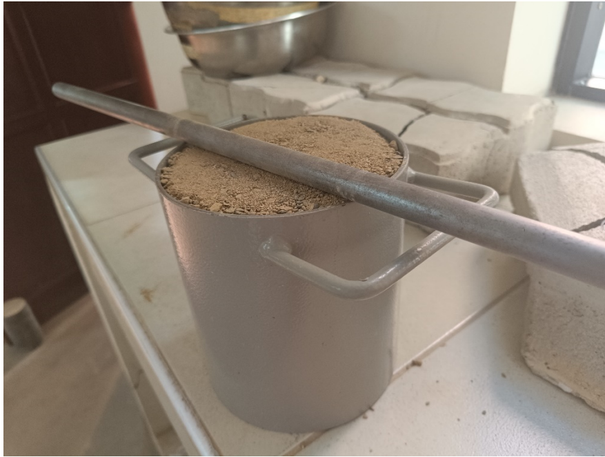
Imagen 13. Obtención del peso unitario de la arena
