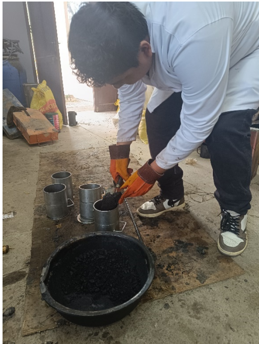
Imagen 32. Colocación de la mezcla en los moldes
