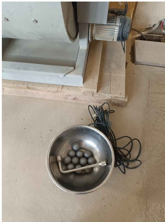
Imagen 16. Material para el ensayo de desgaste de los Ángeles
