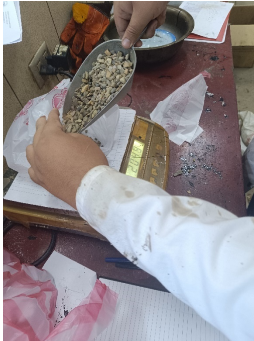
Imagen 29. Dosificación para la realización de briquetas
