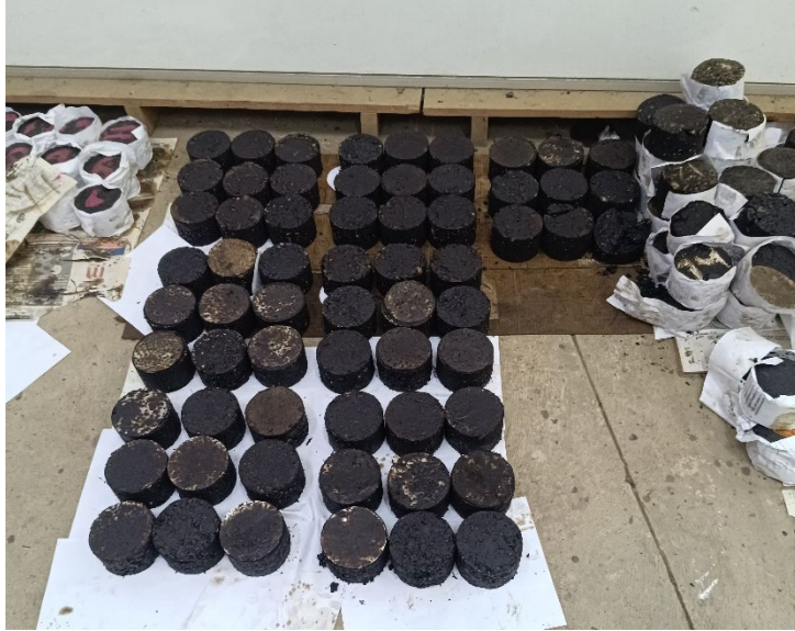
Imagen 41. Briquetas con fibras de acero
