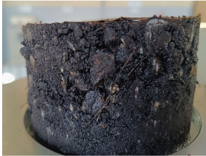
Imagen 39. Briquetas con fibras de acero clasificadas
