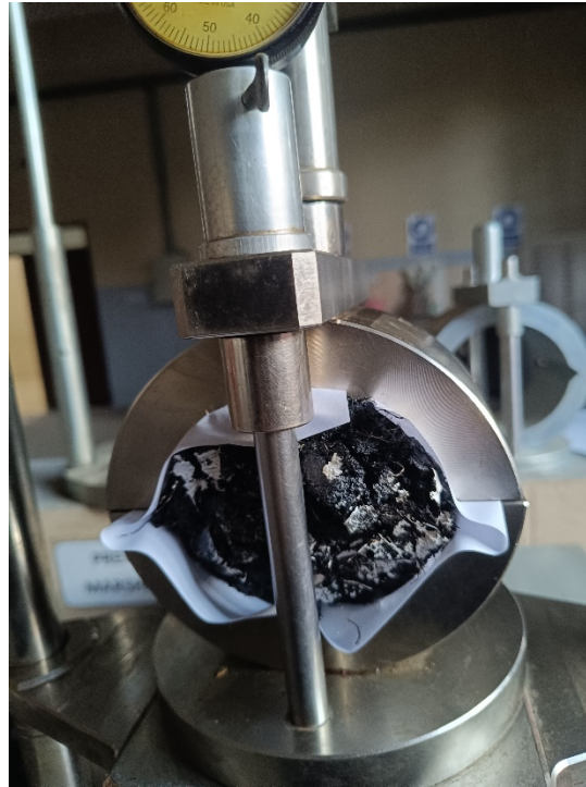
Imagen 36. Ruptura de briquetas
