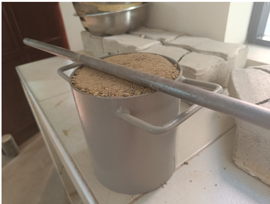
Imagen 12. Obtención del peso unitario de la arena
