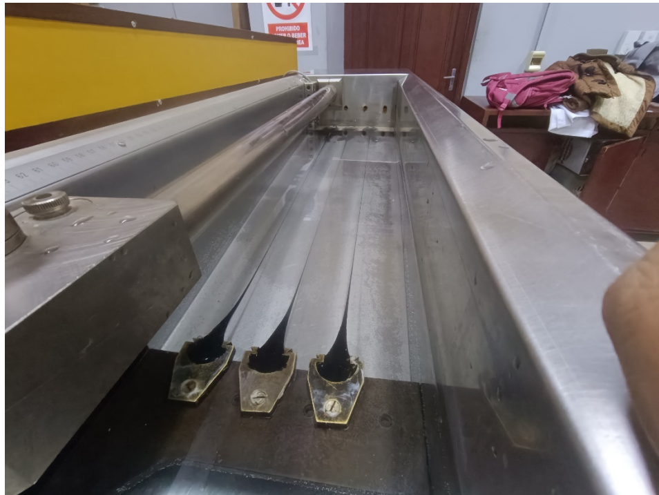
Imagen 28. Ensayo de ductilidad
