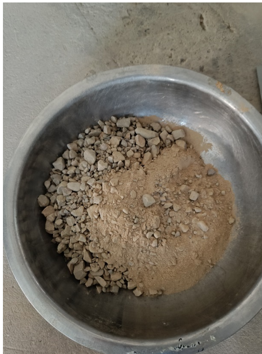
Imagen 18. Agregado después del ensayo de desgaste de los Ángeles
