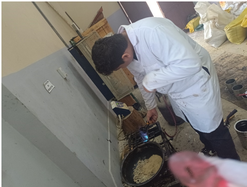
Imagen 30. Preparación de la mezcla asfáltica
