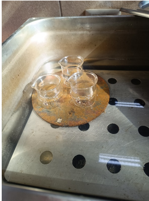
Imagen 23. Ensayo de peso específico de cemento asfáltico
