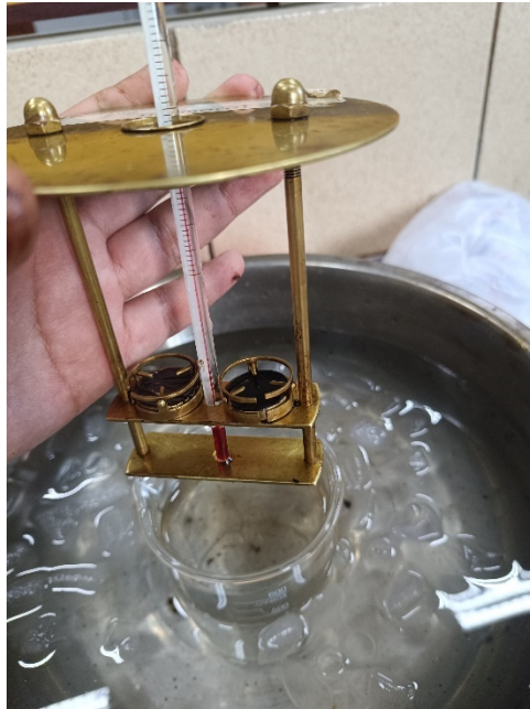
Imagen 21. Ensayo de ablandamiento
