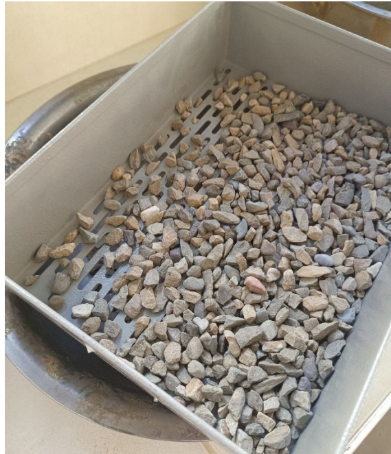
Imagen 15. Tamiz para clasificar agregado alargado
