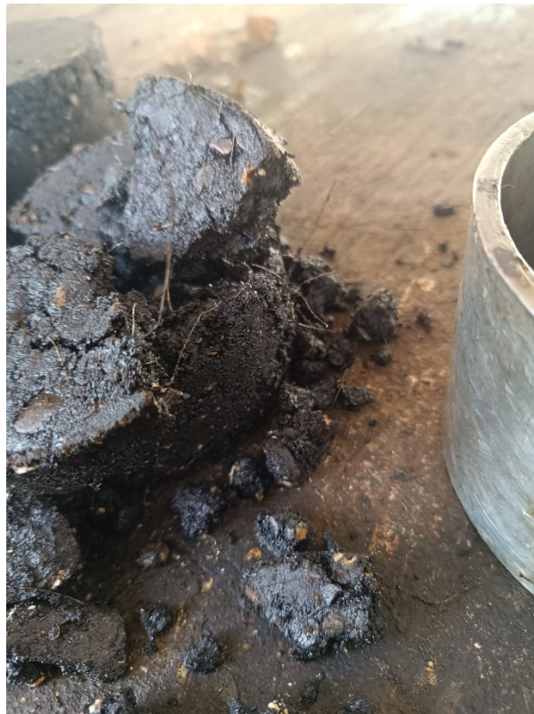
Imagen 40. Briquetas desmoronadas con fibras de acero alargadas
