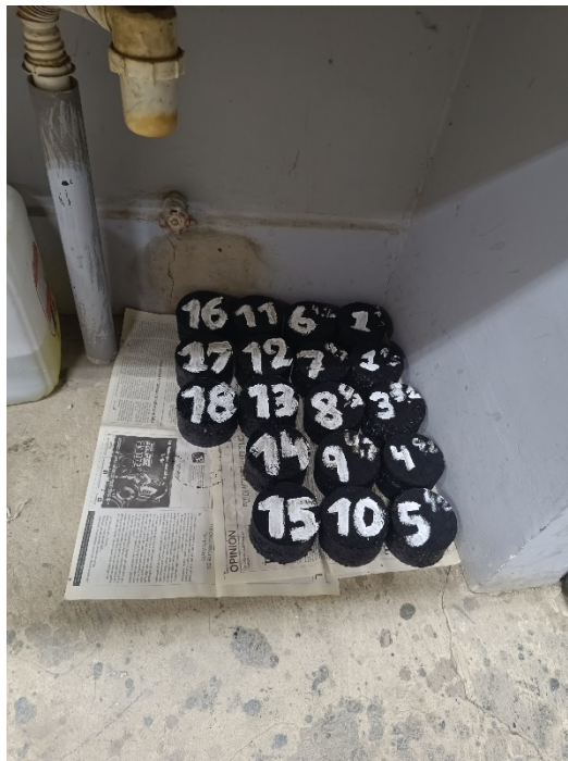
Imagen 34. Briquetas de mezclas asfálticas
