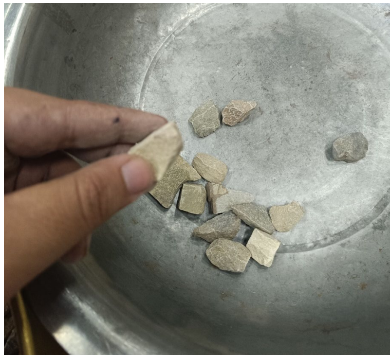
Imagen 14. Separación manual de los agregados para obtener cara fracturas
