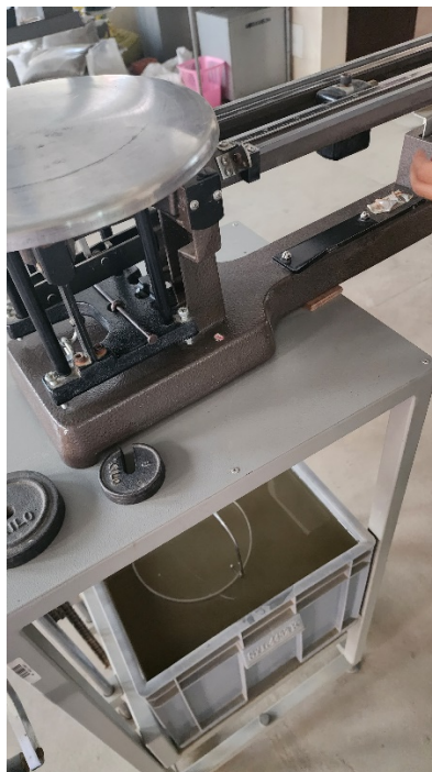
Imagen 6. Obtención del peso específico de los agregados
