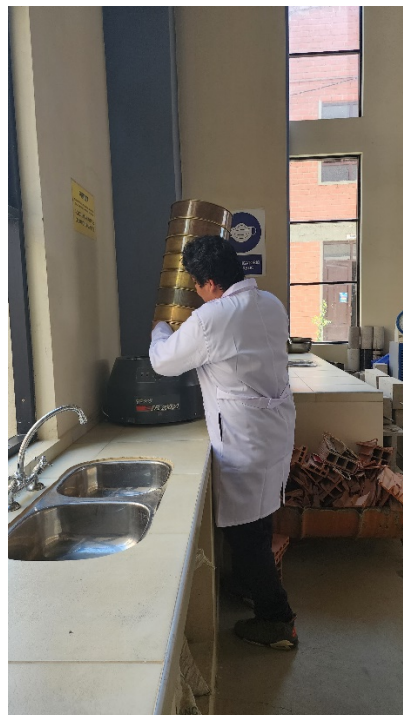
Imagen 4. Ensayo de granulometría de agregados
