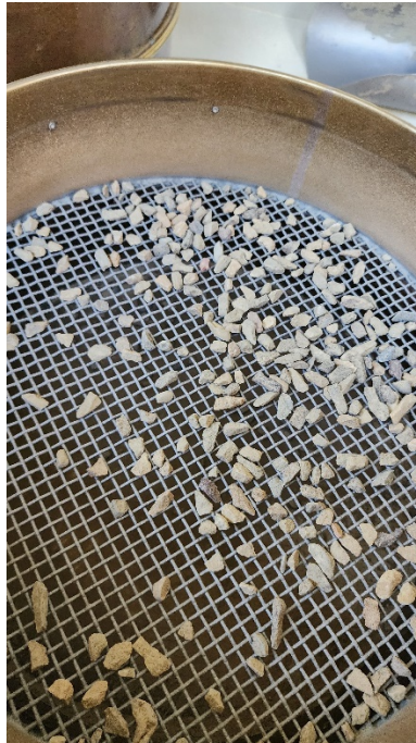
Imagen 5. Retención de materia en los tamices
