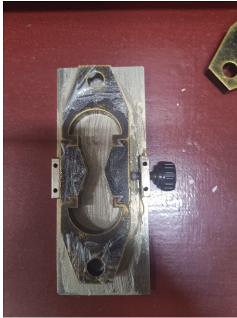
Imagen 27. Engrasamiento de los moldes para ductilidad
