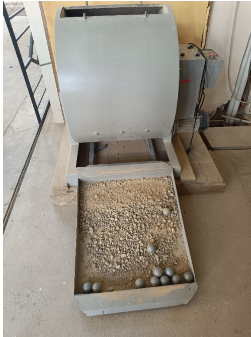
Imagen 17. Agregado después del ensayo de desgaste de los Ángeles
