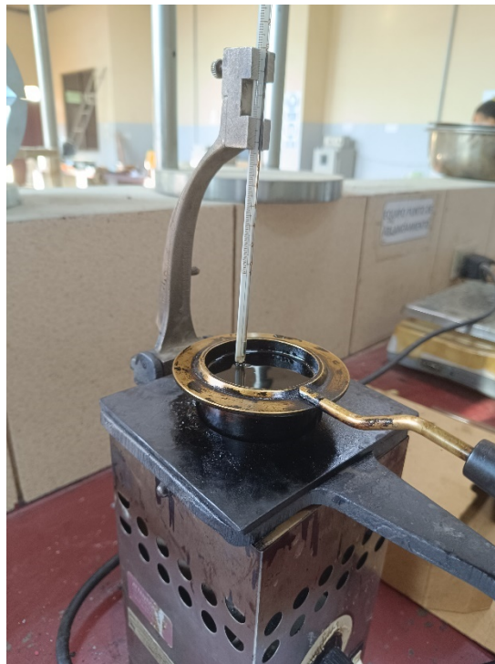
Imagen 22. Equipo para determinar el punto de inflamación
