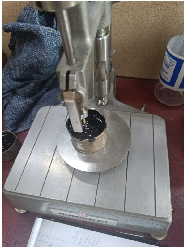
Imagen 20. Ensayo de penetración
