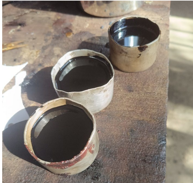
Imagen 19. Muestras para el ensayo de penetración
