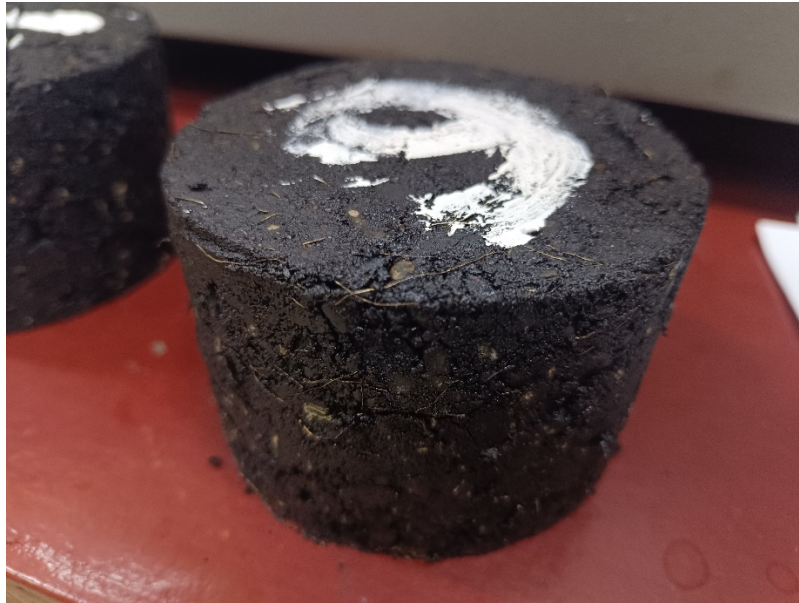
Imagen 35. Briquetas de mezclas asfálticas
