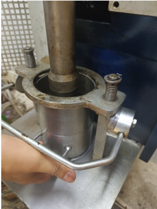
Imagen 33. Compactación de la mezcla asfáltica
