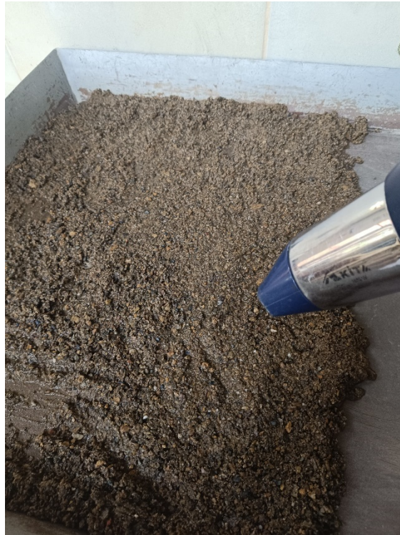
Imagen 7. Uso de secador para el peso específico de la arena
