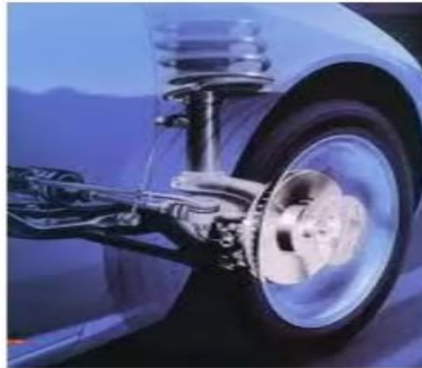
Figura 23. Sistemas de suspensión formados por amortiguadores y resortes
