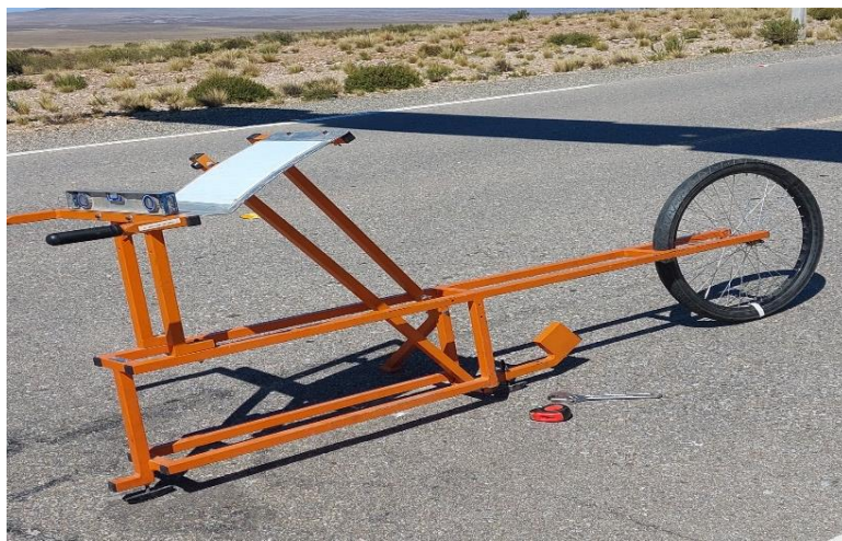
Figura 25. Rugosímetro de Merlín empleado para los ensayos
