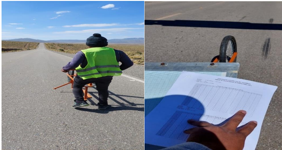
Figura 39. Lectura y toma de datos del ensayo con el rugosímetro de Merlín
