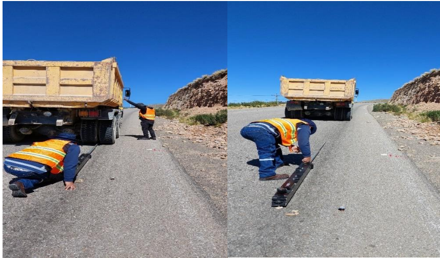
Figura 48. Lectura a diferencias distancias con la viga Benkelman
