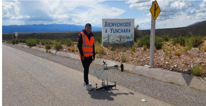
Figura 44. Progresiva final con el ensayo del péndulo británico
