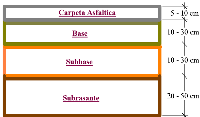
Figura 2. Componentes de un pavimento flexible
