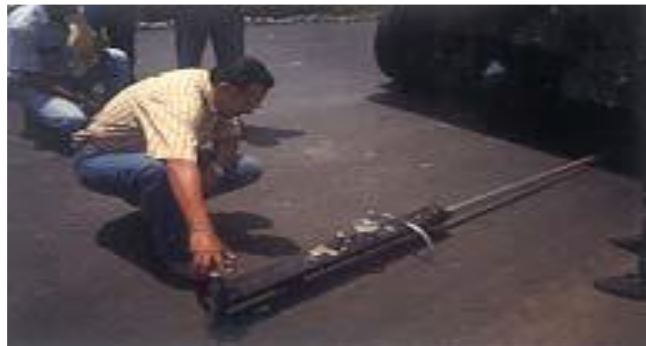
Gráfico 6. Componentes del equipo de viga benkelman
