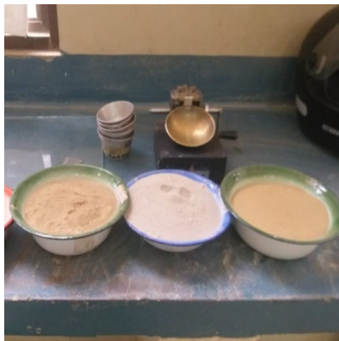
Fotografía 3.5. Realización de ensayo de Casa Grande
