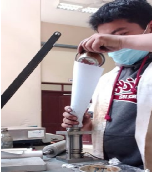
Fotografía 4.3. Peso de las 5 capas que serán sometidas a compactación
