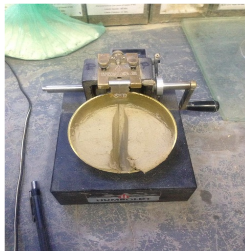
Fotografía 3.5. Realización de ensayo de Casa Grande
