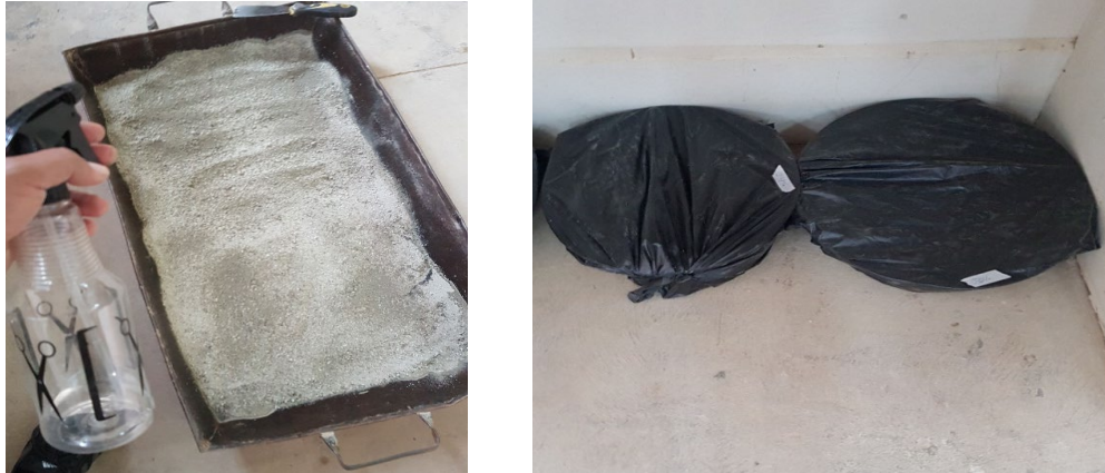
Fotografía 3.16. Muestra con 5 % de humedad para compactación
