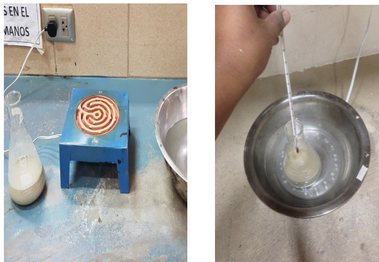
Fotografía 3.11. Gravedad específica de los sólidos
