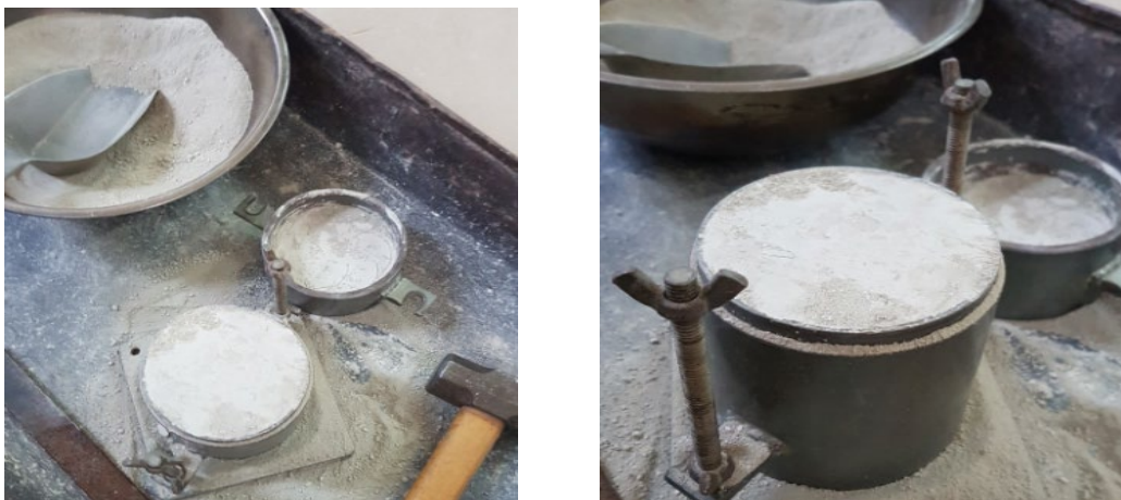
Fotografía 3.17. Compactación de suelo T-99
