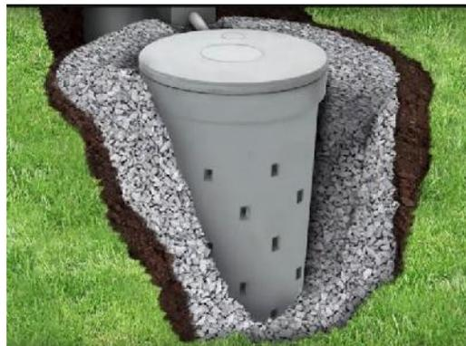
Figura 87. Pozos de infiltración
