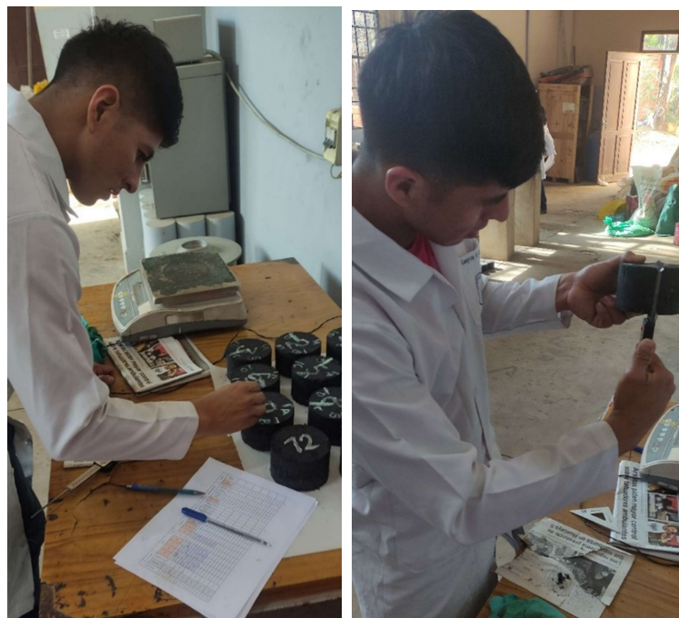
Figura 3.11: Marcado y medición de altura de la briqueleta.
