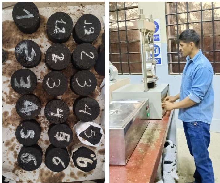
Figura 3.15: Ruptura de briquetas.
