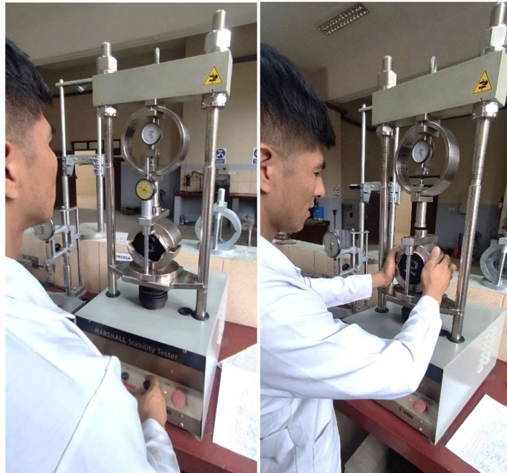
Figura 3.13 Colocación de briqueta al equipo Marshall y ruptura.
