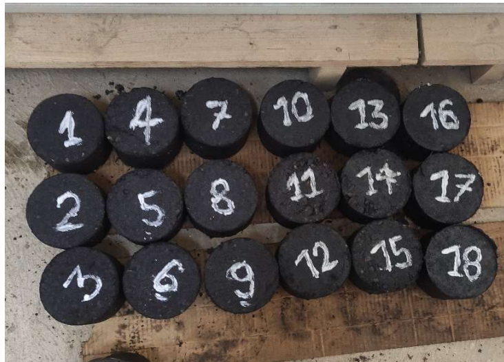
Figura 3.10: Reposo de briquetas según su porcentaje de cemento asfáltico.
