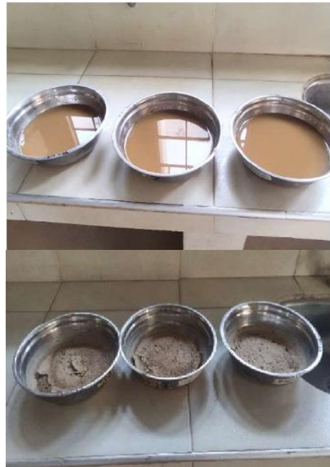
Muestras antes y después de estar en el horno durante 24 horas a 110 °C.
