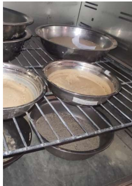
Material secando en el horno a durante 24 horas a 110 °C.
