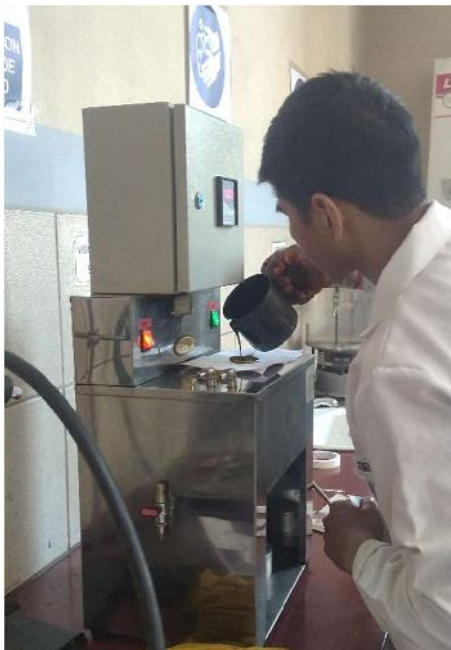
Vertido del cemento asfáltico al orificio del viscosímetro.
