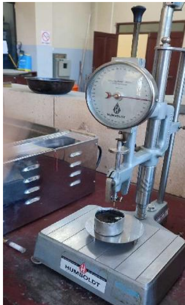
Equipo de penetración con una muestra para realizar el ensayo.
