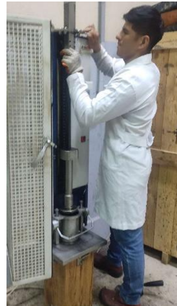
Proceso de compactación de la briqueta de ensayo.
