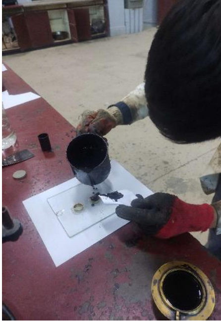
Llenado de cemento asfáltico a los anillos.
