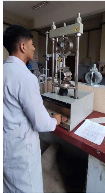
Proceso de ruptura de briqueta mediante equipo Marshall.
