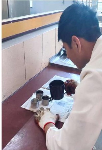
Vaciado del cemento asfáltico a las taras de ensayo.
