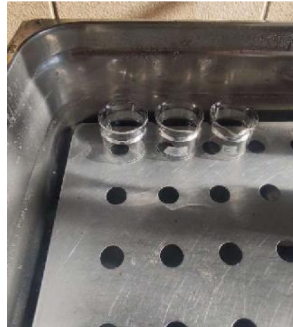
Muestras de ensayo en baño maría a 25°C por un periodo de 30 minutos.
