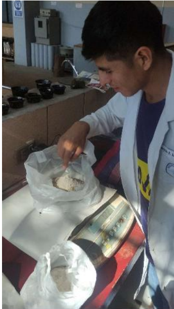
Pesaje del agregado según dosificación.
