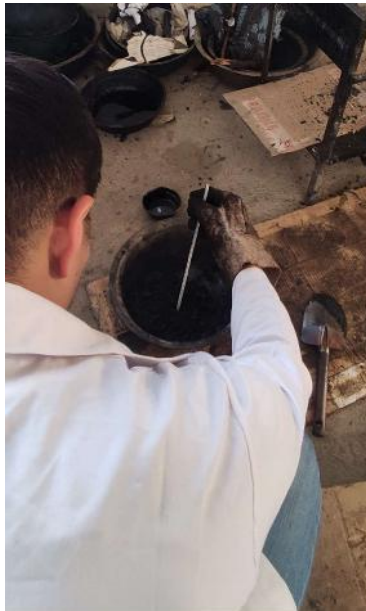
Medición de la temperatura de la mezcla asfáltica.
