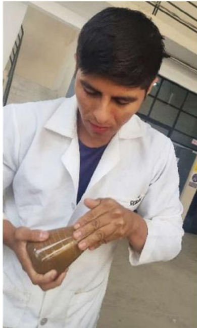
Eliminacion de burbujas de aire.
