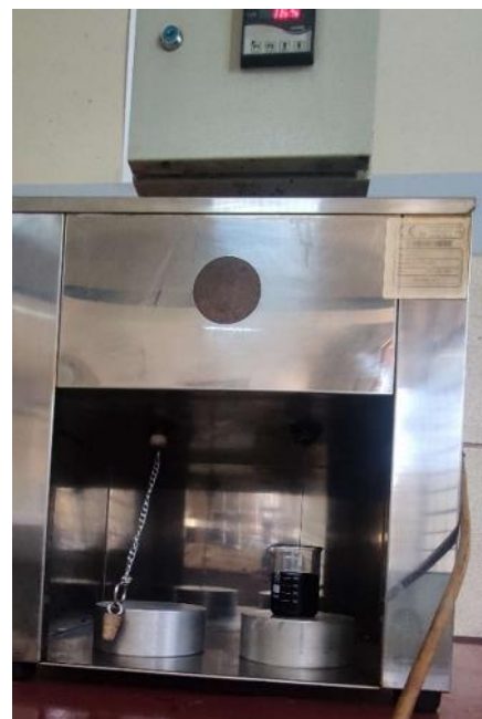
Caída del cemento asfáltico al vaso de precipitado
