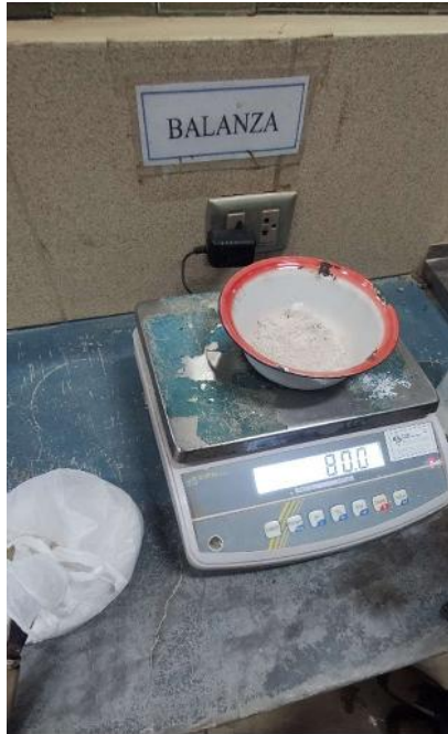
Pesaje del filler talco industrial.
