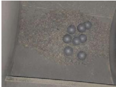
Vaciado del agregado y las esferas a la máquina de los Ángeles.
