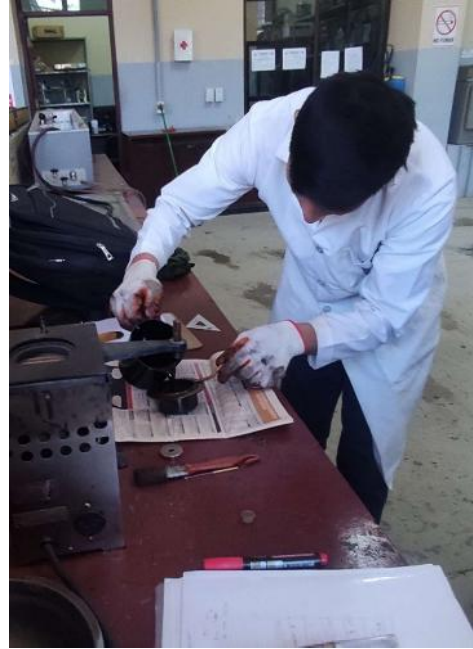
Vaciado del cemento asfáltico a la copa de Cleveland.
