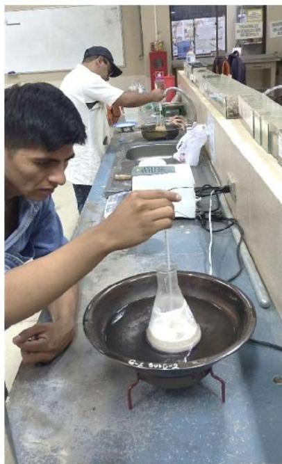
Baño María y medición de la temperatura de la muestra de ensayo.
