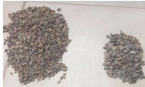
Partículas separadas en dos grupos: fracturadas y no fracturadas.
