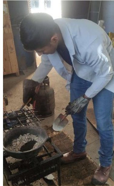
Mezcla del agregado con el cemento asfáltico.
