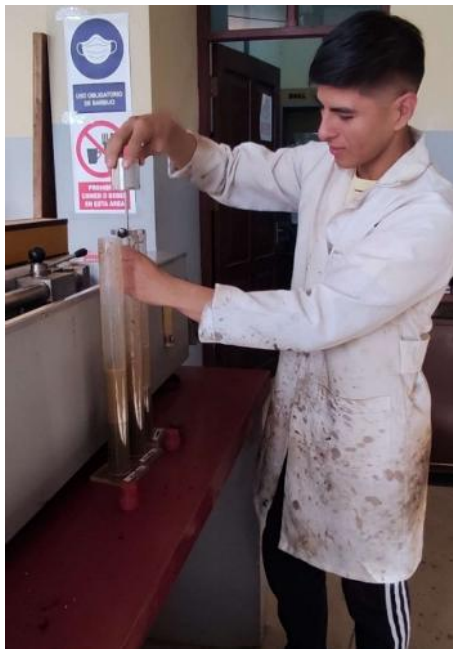
Introducción del pisón en el cilindro para ayudar a sedimentar la muestra.
