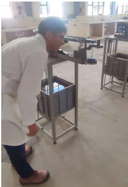
Pesaje del agregado sumergido en agua mediante una balanza hidrostática.
