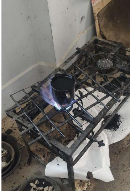
Calentado del cemento asfáltico.
