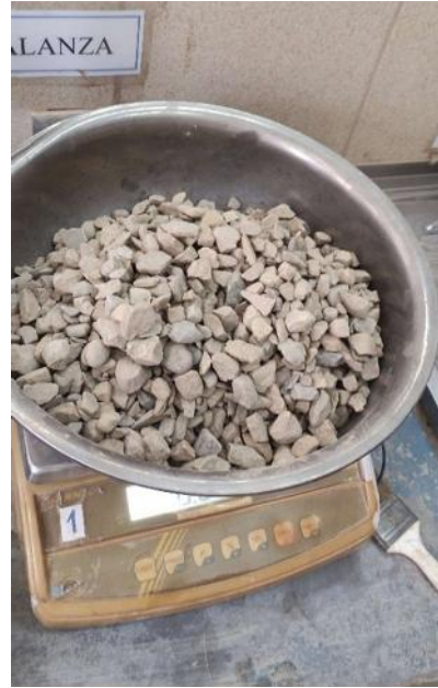
Pesaje del agregado grueso.
