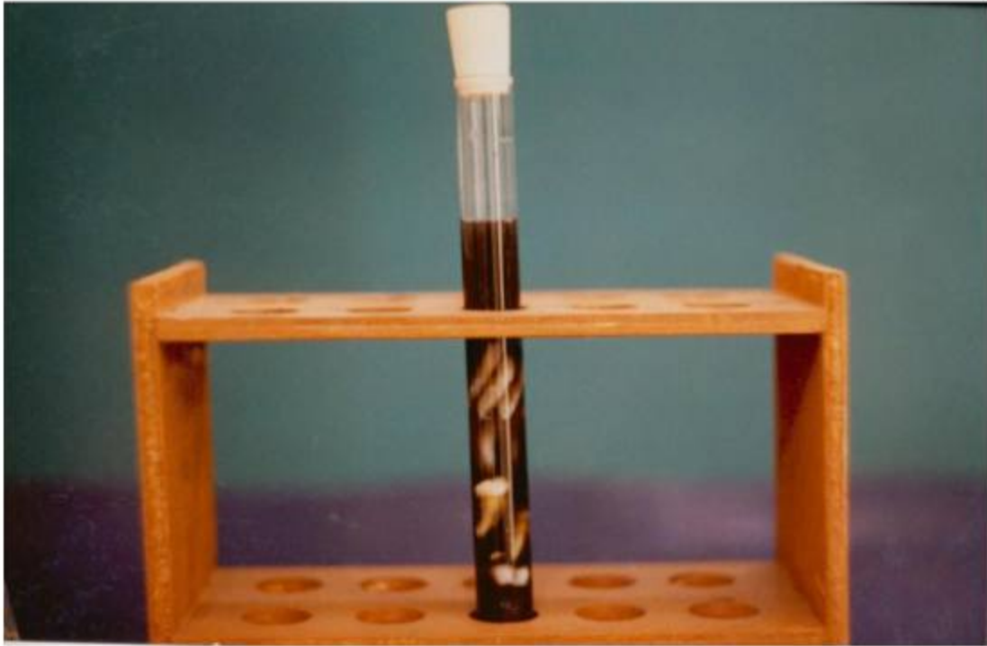
Fig. 18 .- a) Tubo de ensayo con piezas dentarias sumergidas en un baño de tinta China.
