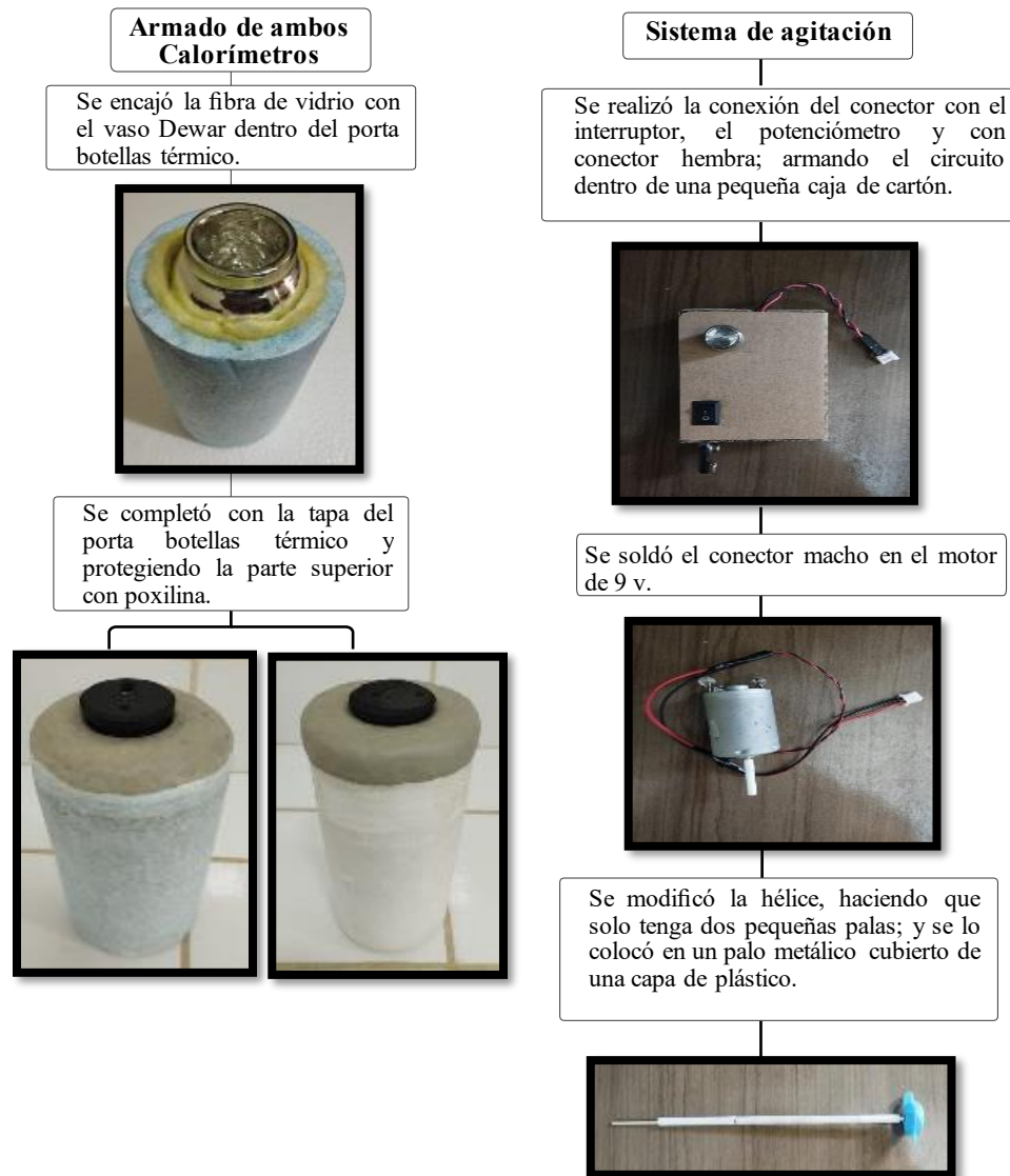
Figura 3.7: Procedimiento para la construcción de ambos calorímetros y del sistema de agitación
