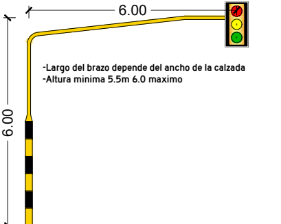
UBICACIÓN TRANSVERSAL DE SEÑALES VERTICALES Distancia y Altura Señal Tipo Mapa Esc: 1/100
