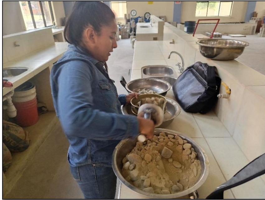
Figura 11. Tamizado de material después del desgaste
