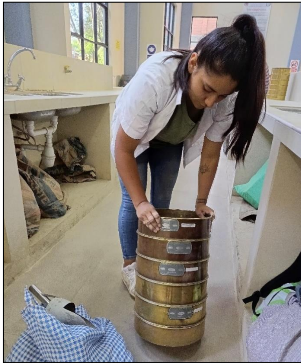
Figura 6. Tamizado de los agregados
