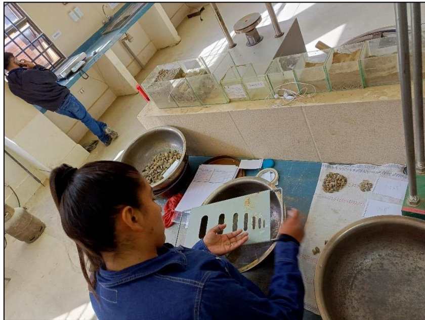
Figura 4. Proceso del ensayo de partículas planas y alargadas
