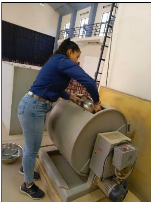
Figura 7. Introducción de agregados a la máquina de desgaste de los Ángeles
