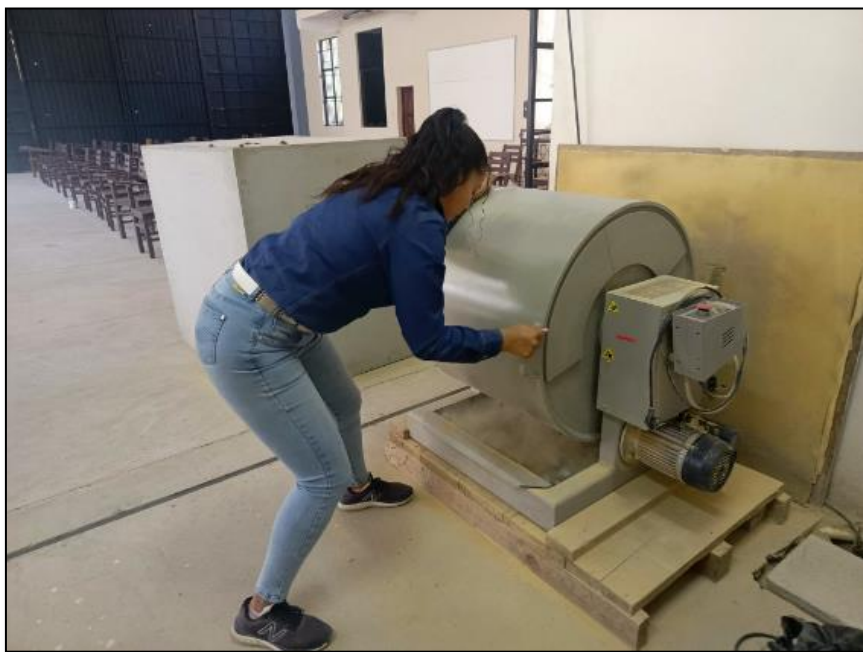
Figura 8. Manipulación de la máquina de los Ángeles después de las revoluciones
