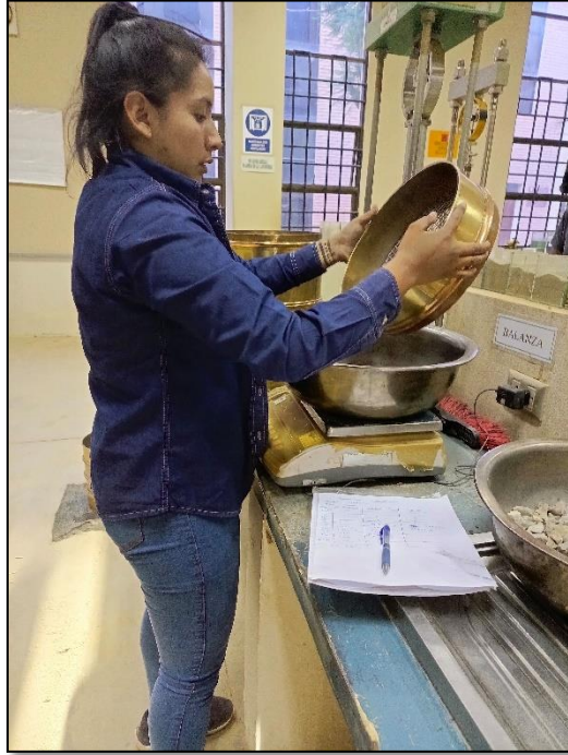
Figura 3. Pesaje de los agregados de granulometría
