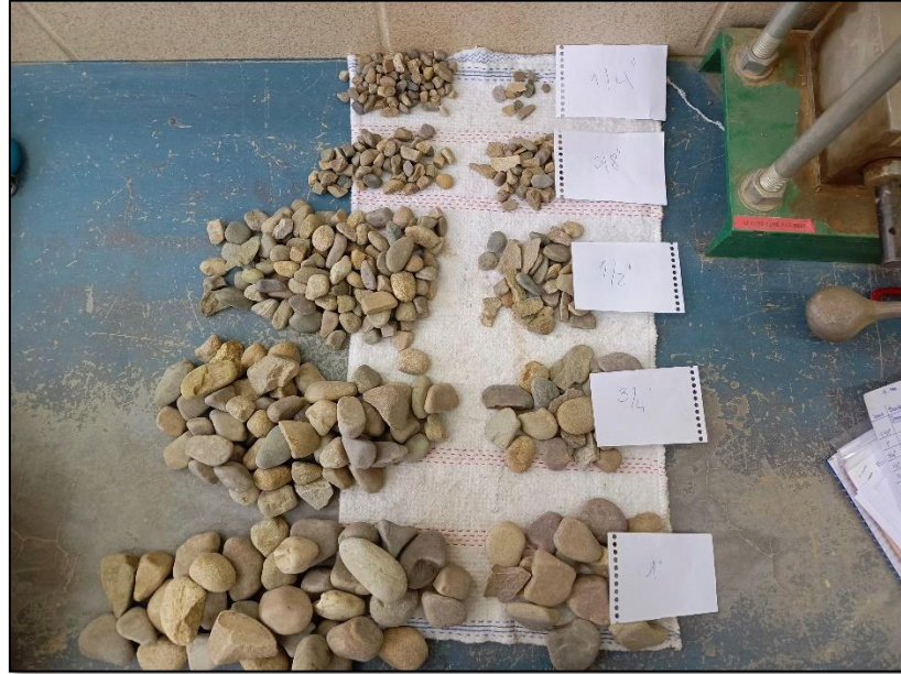
Figura 5. Agregados separados entre planas y alargadas
