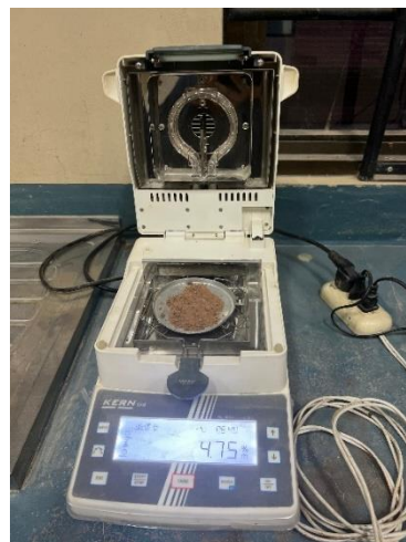
Contenido de humedad en la termobalanza
