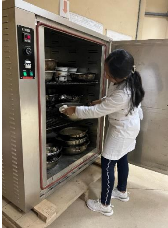
Colocado de la bandeja más muestra al horno
