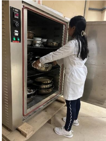
Colocado de la muestra lavada al horno
