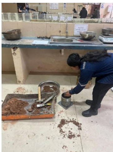
Colocación de la muestra en el molde
