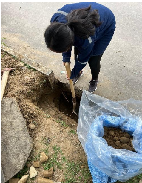
Extracción de la muestra conservando la humedad natural
