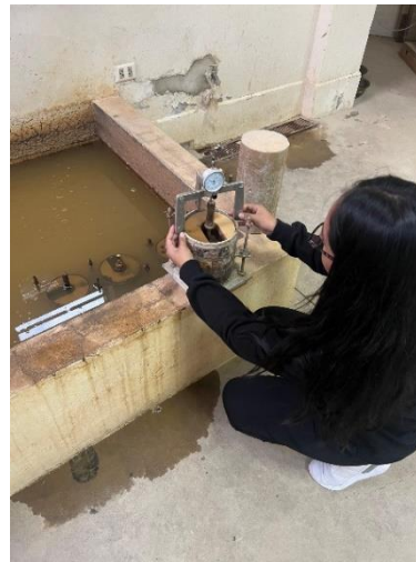
Medición con el extensómetro
