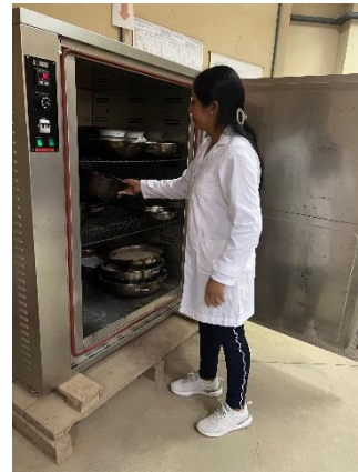
Colocado de las taras al horno
