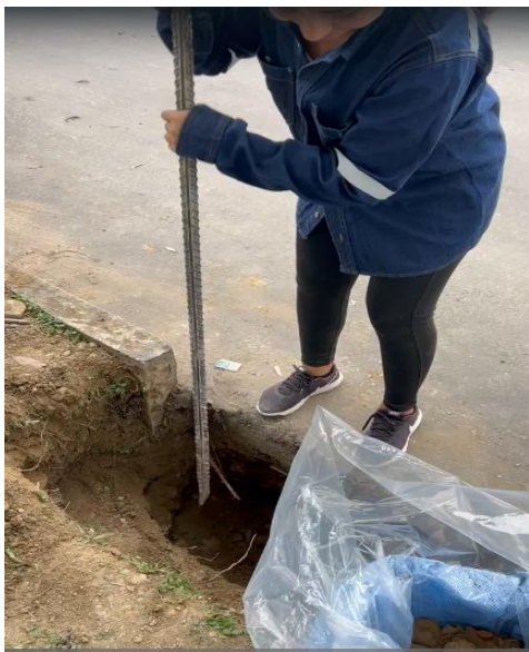
Apertura para la extracción de muestra
