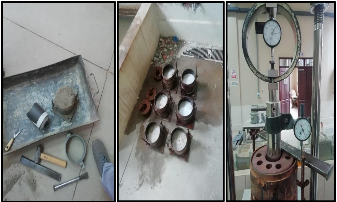
Imagen 3.9. Ensayo de CBR
