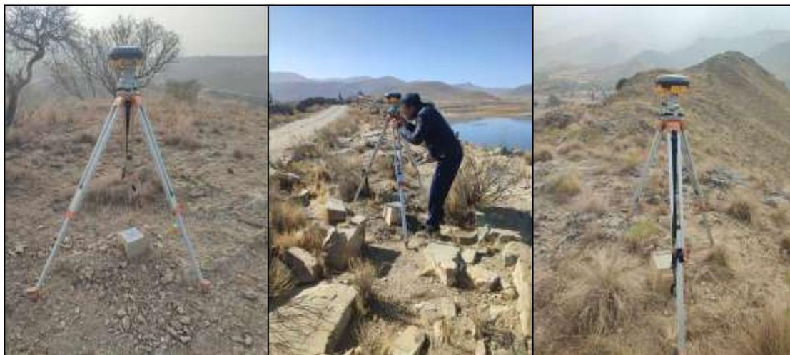
*Ilustración 11 Equipos GNSS en el campo.*
