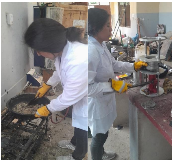
Figura 3.18. Ensayo de compactación de briquetas
