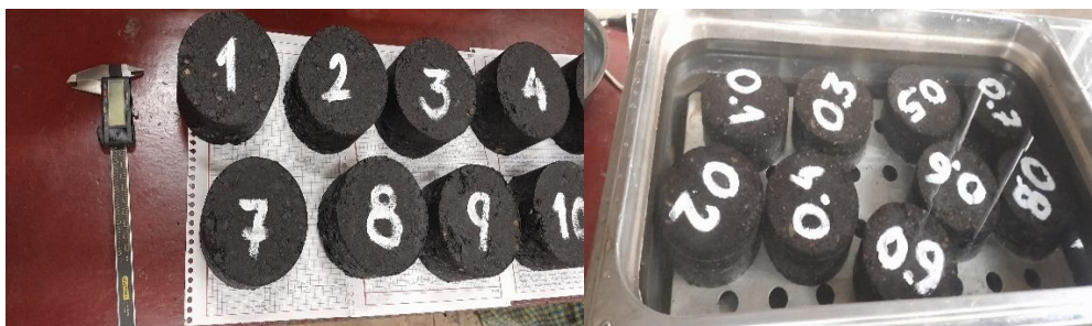
Figura 3.20. Medición y baño maría a 60^\circ\text{C} de briquetas
