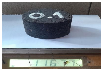
Figura 3.19. Peso de briqueta en estado seco
