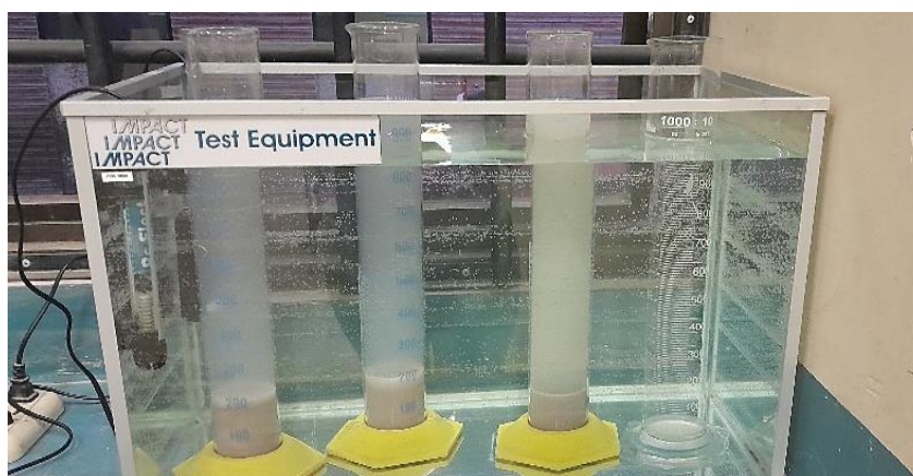
Figura 3.11. Ensayo de Granulometría por Hidrómetro
