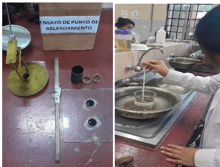
Figura 3.15. Ensayo de punto de ablandamiento
