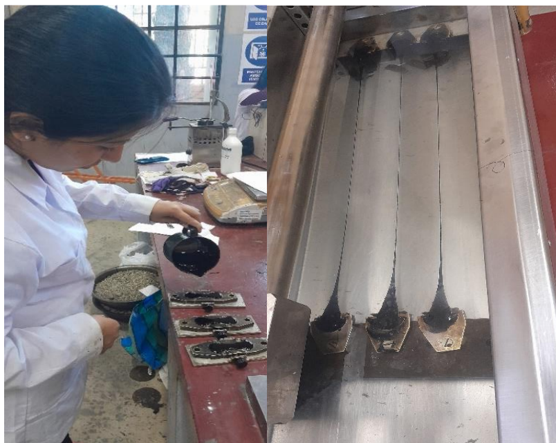
Figura 3.16. Ensayo de ductilidad
