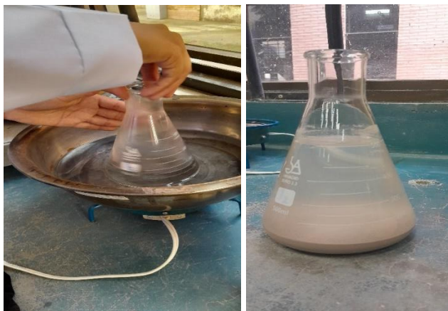
Figura 3.10. Ensayo calibración de frasco y peso específico de ceniza
