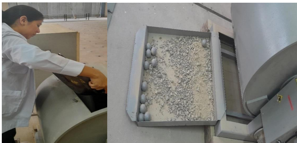
Figura 3.6. Ensayo de desgaste de los ángeles de agregado grueso
