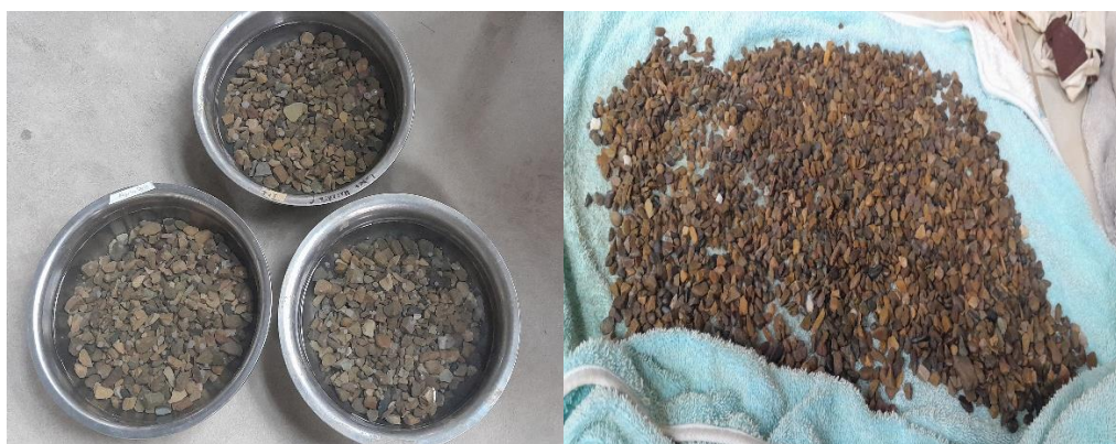
Figura 3.4 Sumersión y secado de grava y gravilla
