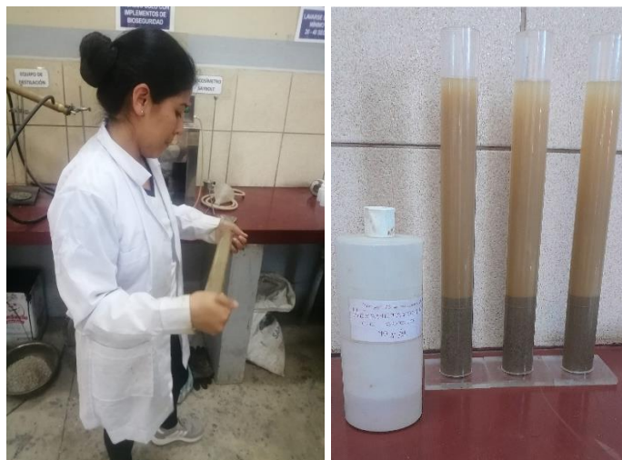
Figura 3.8. Ensayo de equivalente de arena
