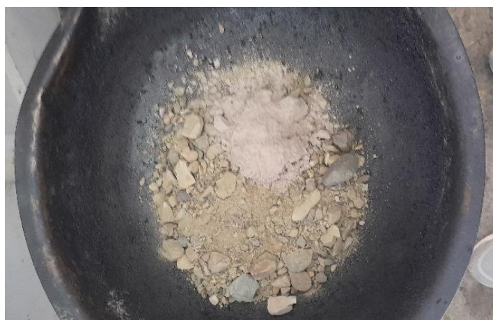
Figura 3.17. Proceso de calentamiento de agregados con ceniza orgánica
