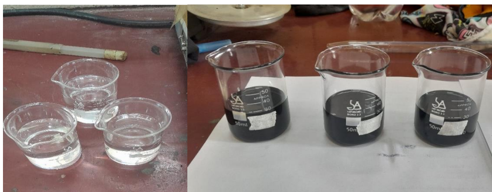
Figura 3.13. Ensayo peso específico del asfalto
