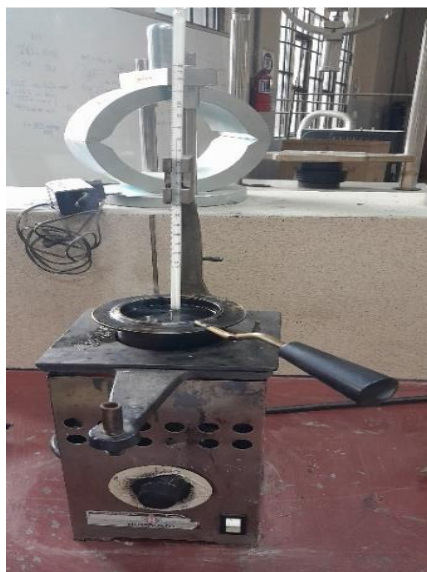
Figura 3.14. Ensayo de punto de inflamación
