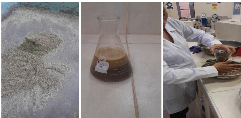
Figura 3.5. Ensayo de peso específico y absorción de la arena
