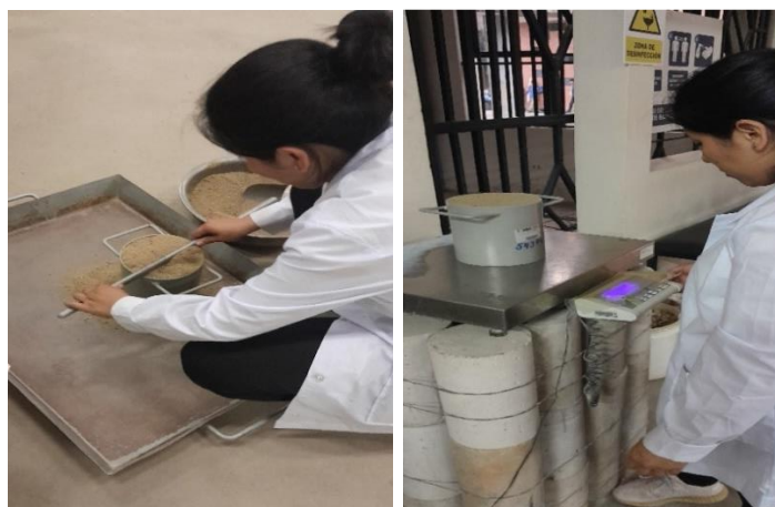
Figura 3.7. Ensayo de peso unitario de agregados
