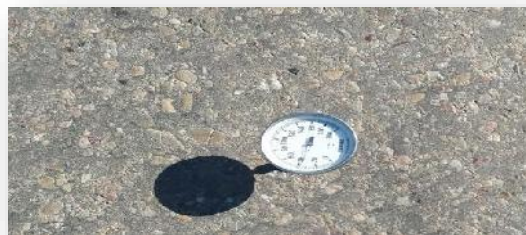
Figura 3.13: Medicion de la temperatura
