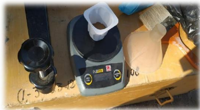
Figura 3.10: Materiales círculo de arena
