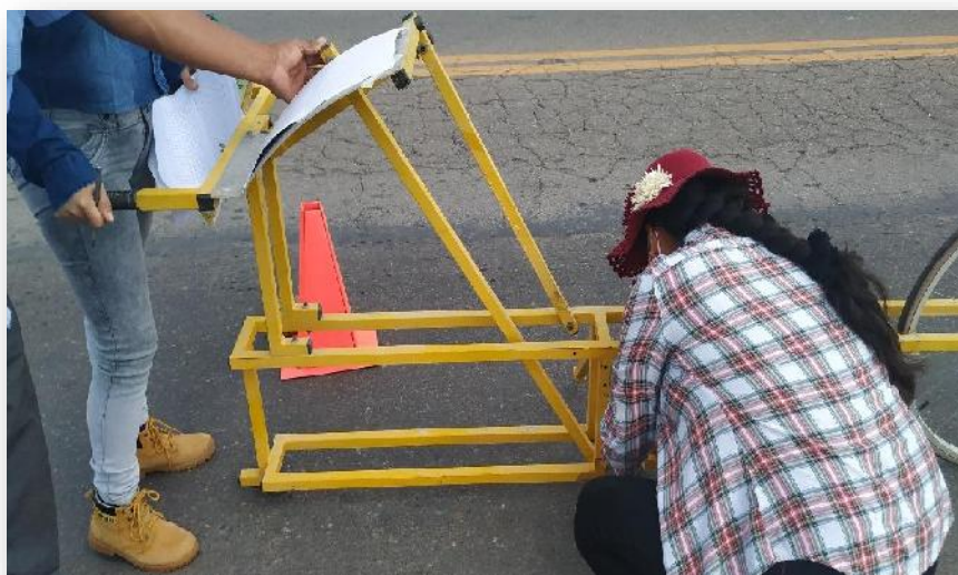
Figura 3.5: Calibración del equipo Merlin
