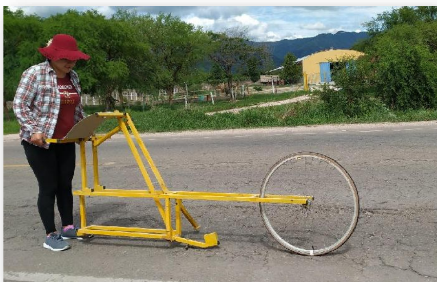
Figura 3.6: Manejo del Rugosímetro Merlin
