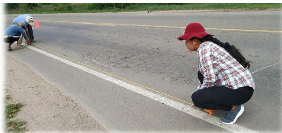
Figura 3.7: Procedimiento del PCI
