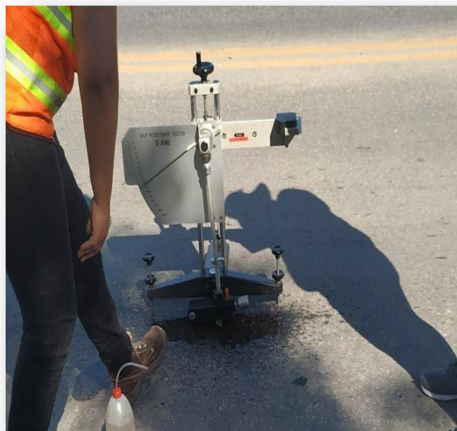
Figura 2.33: Equipo de medición, péndulo de fricción
