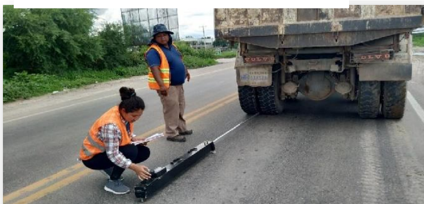
Figura 3.14: Ensayo de la viga Benkelman
