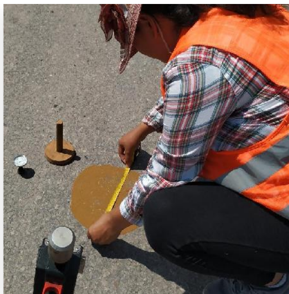
Figura 2.32: Ensayo círculo de la arena
