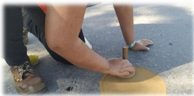
Figura 3.11: Procedimiento de ensayo círculo de arena
