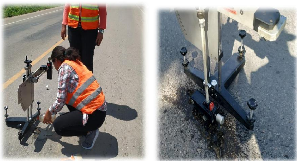
Figura 3.9: Procedimiento de medición del péndulo
