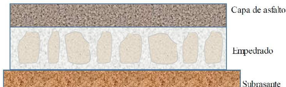
Figura 2.4: Perfil transversal de pavimento articulado
