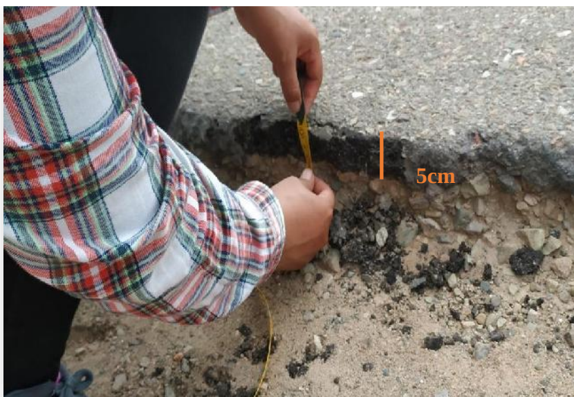
Figura 3.3: Espesor de la capa de rodadura
