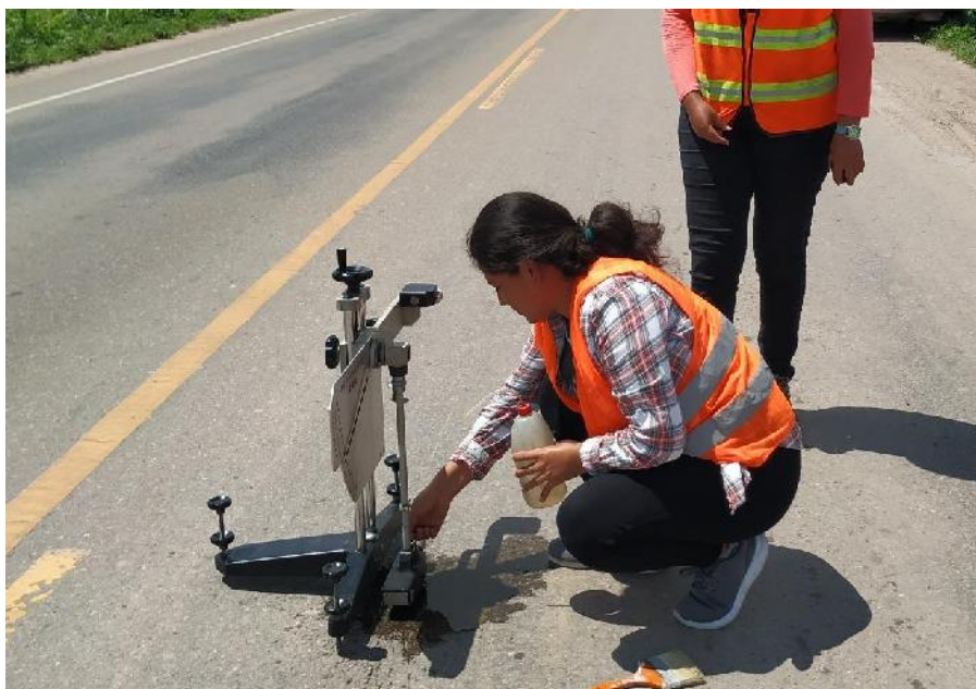
Fotografía 21: Medición del Péndulo de fricción coord. 21°54' 02.24" S 63°37'53.87" O (0+400) carril ida
