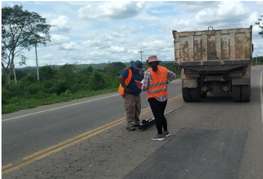
Fotografía 28: lectura de datos Viga Benkelman coord. 21°52'41.84" S 63°37'21.97" O (3+200) carril vuelta
