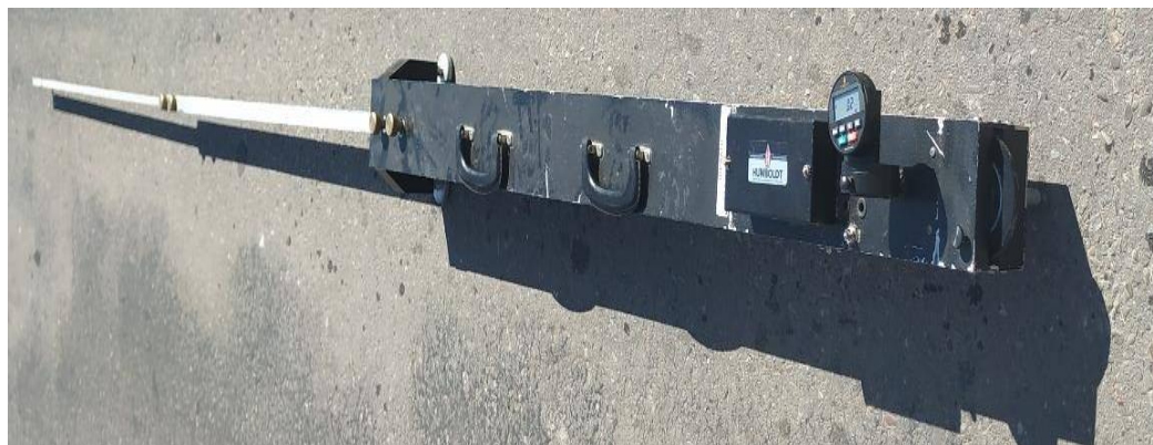
Fotografía 25: Instrumento Viga Benkelman
