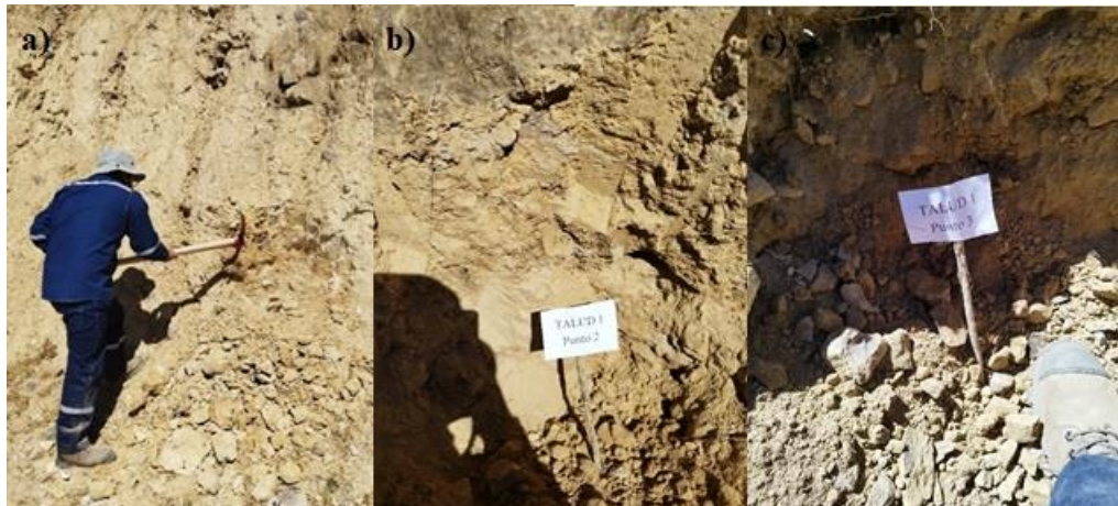
Figura 3.6 Recolección de muestra de suelos del talud a) Pie b) Cuerpo c) Cabeza
