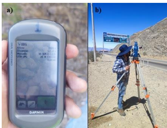
Figura 3.5 a) "GPS" Instrumento geodésico b) Estación total SOKKIA SET 5X
