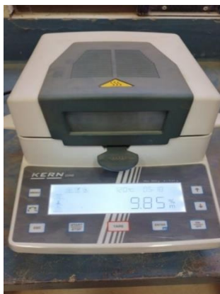
Figura 3.10 Contenido de humedad talud N°1 P1
