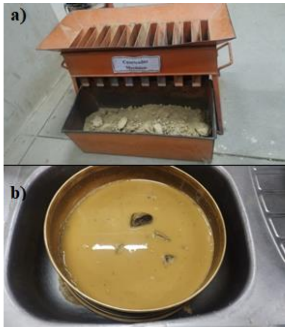
Figura 3.7 a) Cuarteo de suelo b) Lavado de suelo por tamiz N° 200
