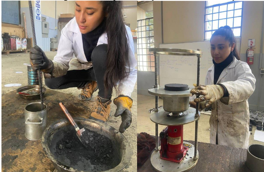
Figura.28. Compactación y Desmolde de la briqueta.
