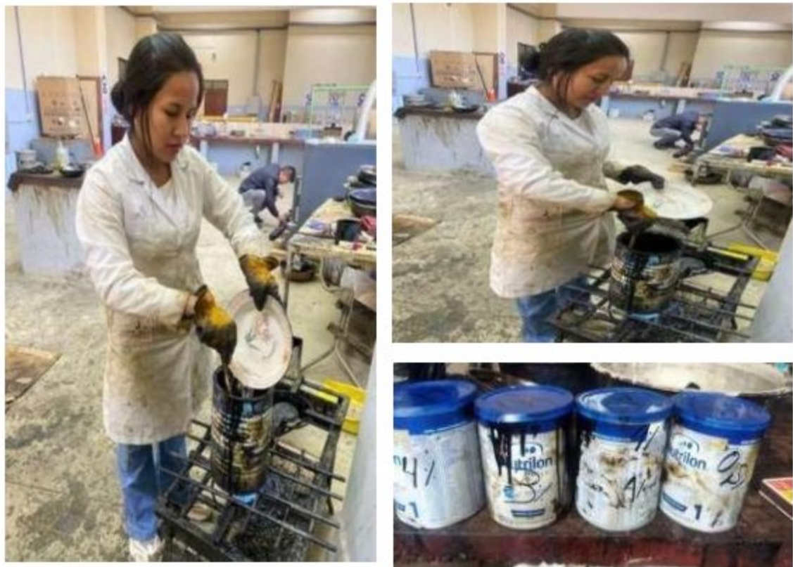
Foto 13: Mezclado del aditivo con el cemento asfáltico 85-100
