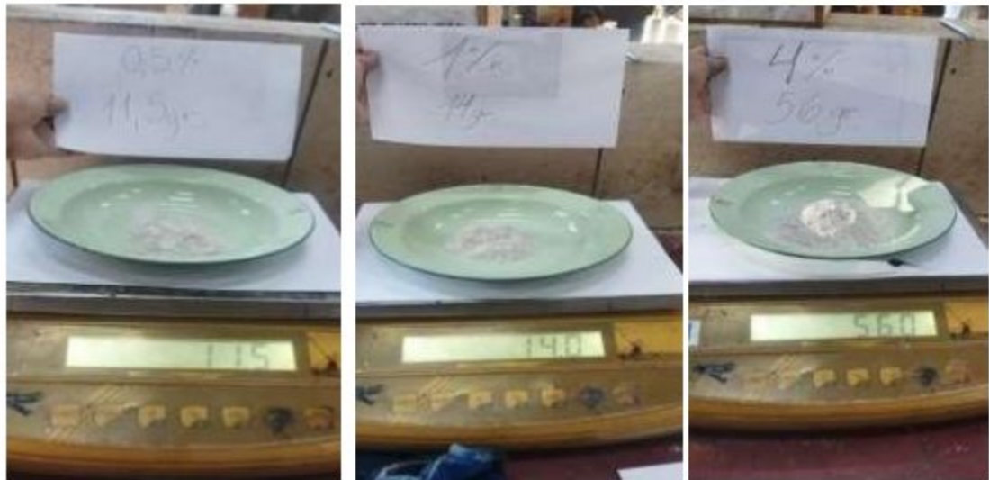
Foto 13: Mezclado del aditivo con el cemento asfáltico 85-100
