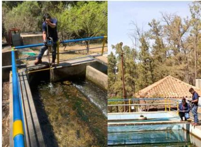
**Figura 4.4 Medición de velocidades en secciones de control.**
