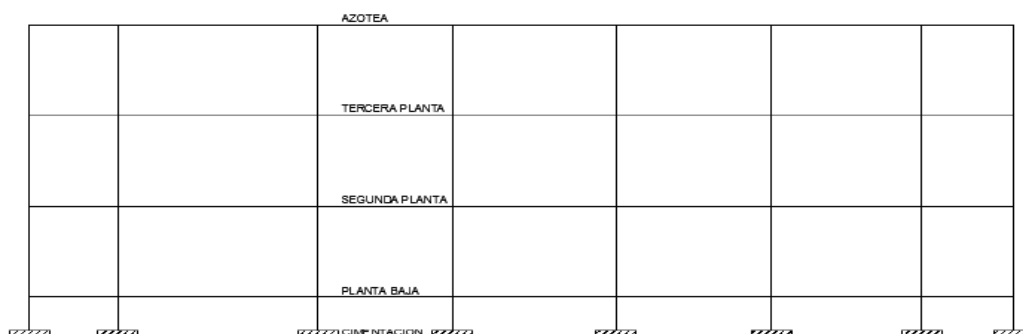
Figura 2.7: Planteo estructural de la estructura porticada
