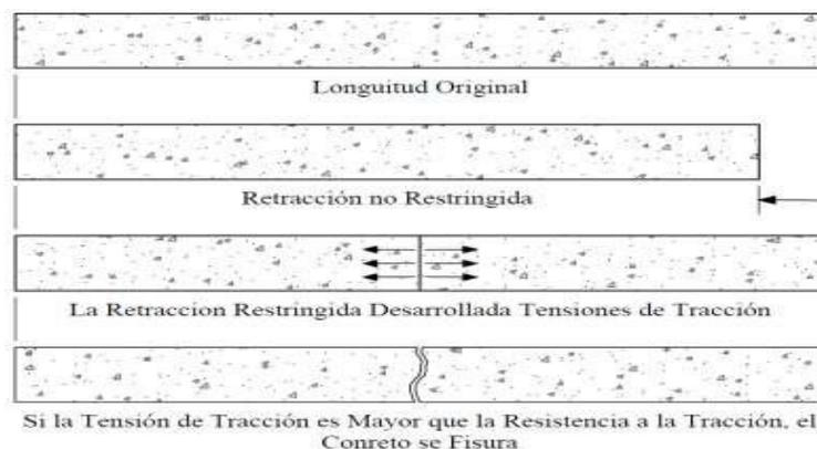
*Fuente: Fisura del hormigón generado por la retracción plástica (ACI-244R, 2001)*
