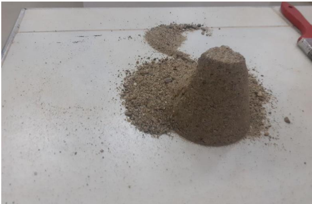
Prueba del cono y pisón para ver si está saturada superficialmente seca.
