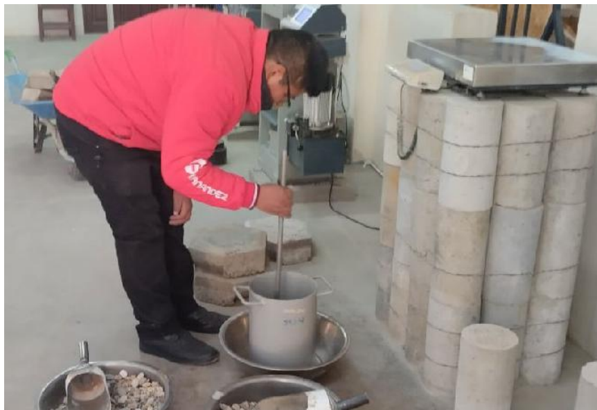
Varillado para el ensayo de peso unitario del agregado grueso.
