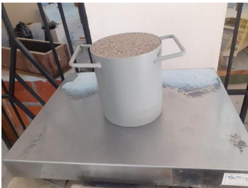
Pesado de la arena compactada.
