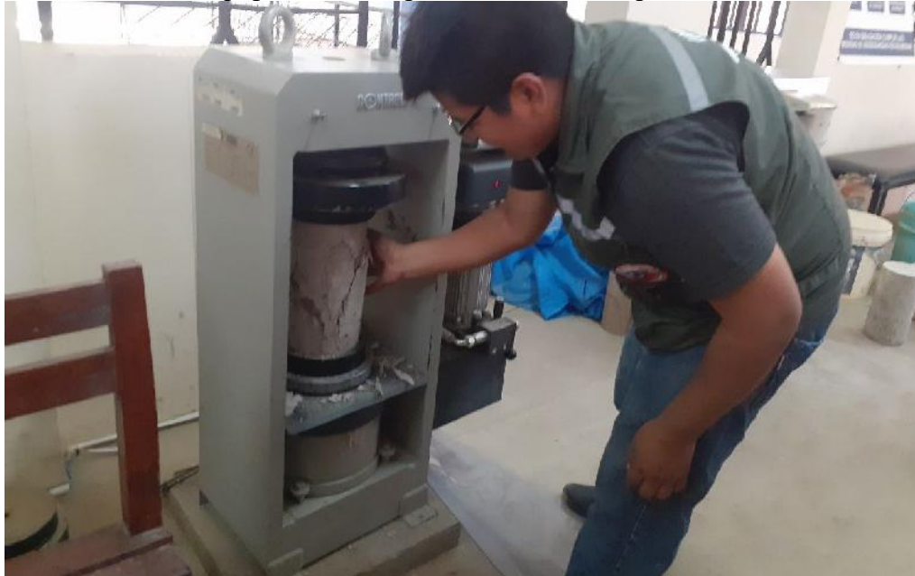
Rotura de probeta con la prensa hidráulica semiautomática.
