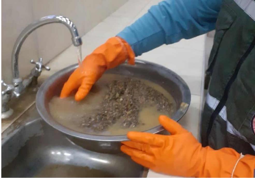
Lavado de la arena porque contiene más del 5% de finos en su granulometría.
