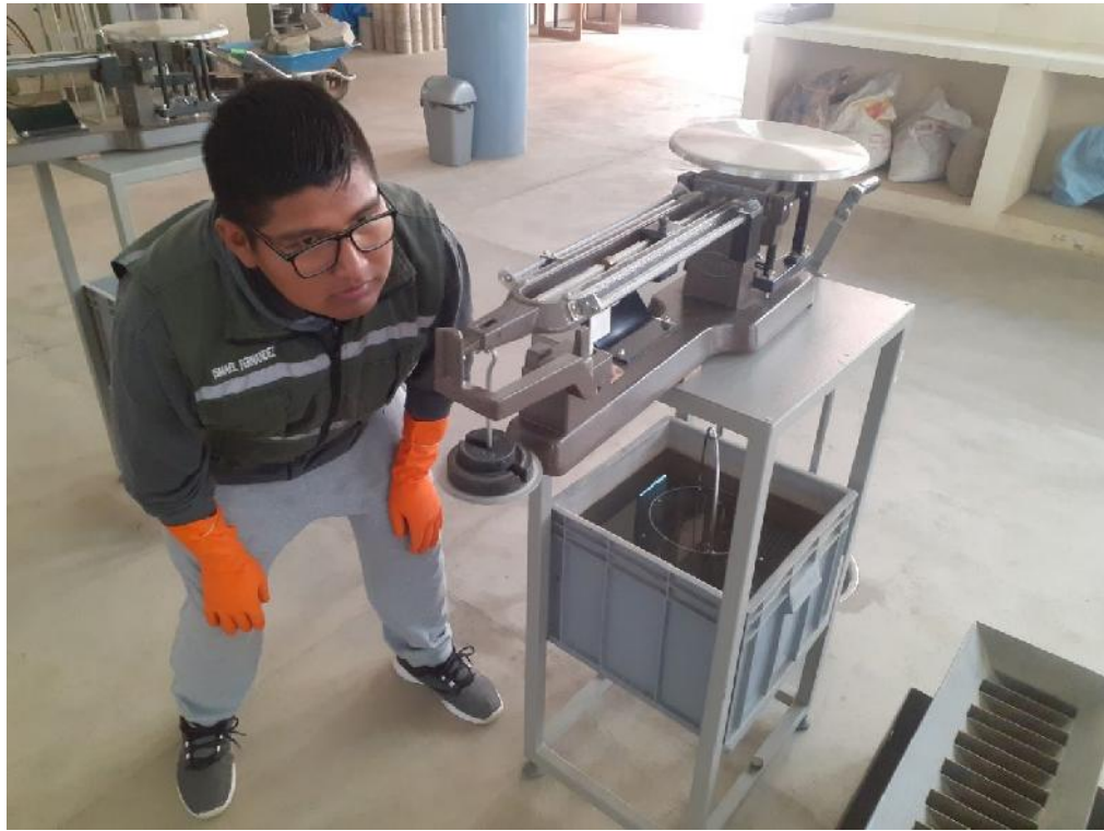
Medición del peso sumergido del agregado grueso
