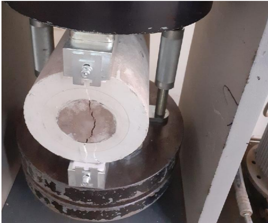
Rotura de probeta a tracción indirecta.
