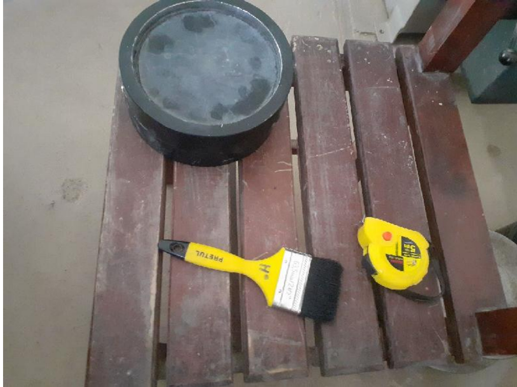
Equipo necesario para la rotura a compresión.
