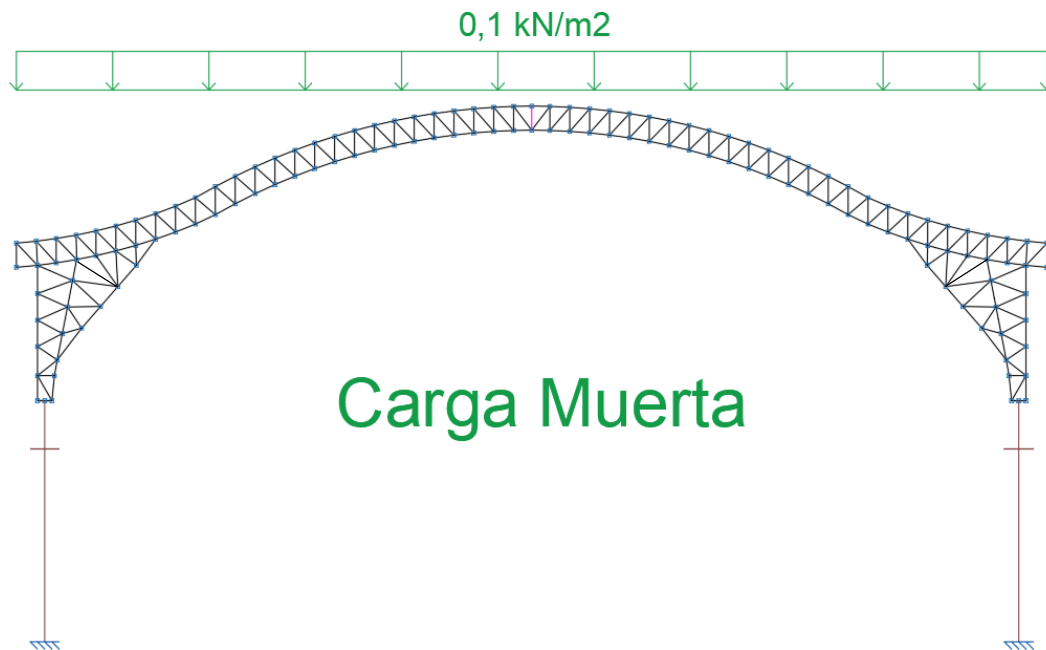
Figura 3.10 Carga muerta que actúa en el tinglado
