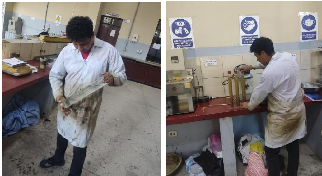
Fotografía 1. Ensayo del Equivalente de Arena
