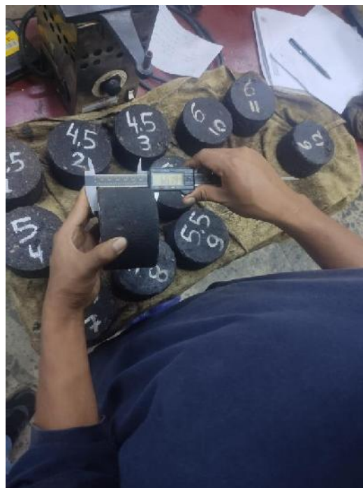
Fotografía 8. Preparación de Briquetas y prueba Marshall
