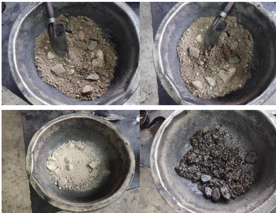
Fotografía 5. Preparación de las mezclas asfálticas
