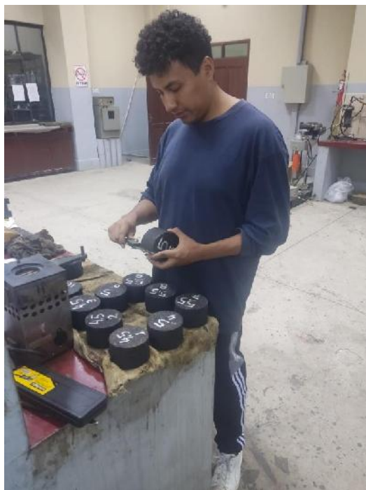
Fotografía 8. Preparación de Briquetas y prueba Marshall
