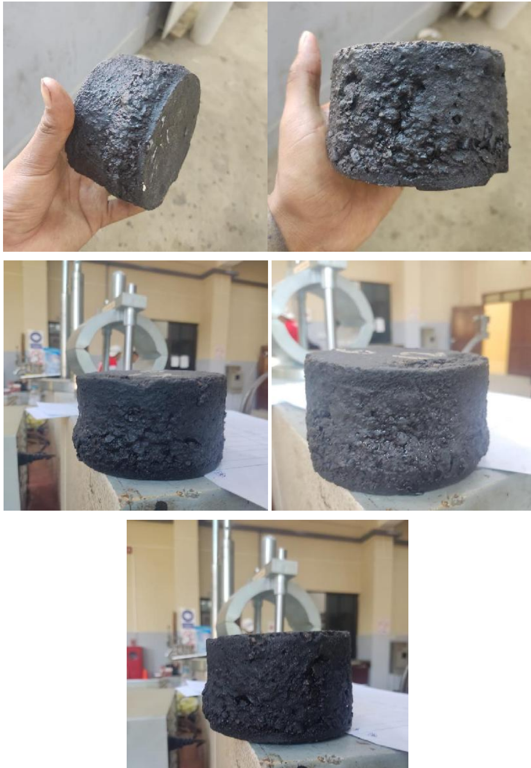
Fotografía 9. Briquetas después del ensayo Marshall
