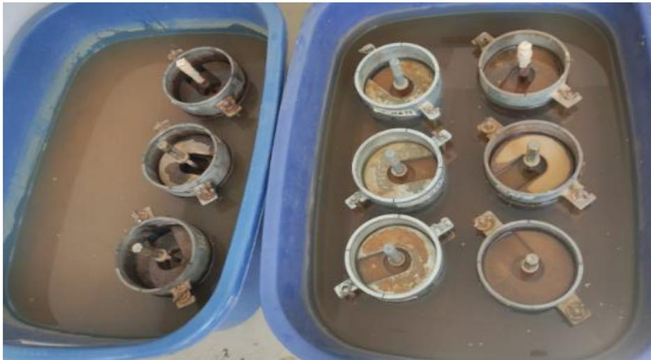
**Figura: 3.27 muestras CBR sumergidas**
