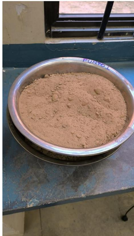
Material secado en horno 24 hrs
