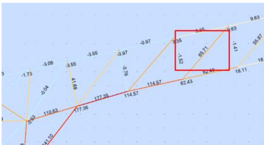
Figura 3-24: Esfuerzo axial de compresión barra 769
