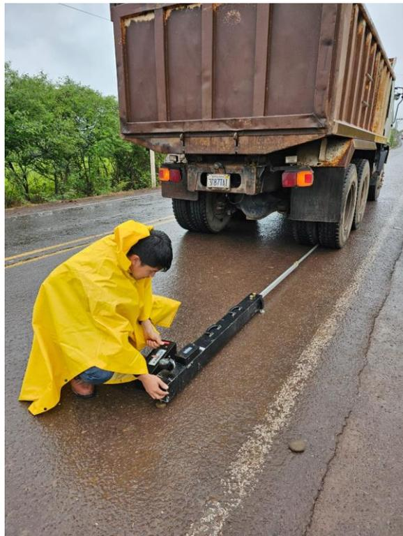
**Calibración de la Viga Benkelman**
