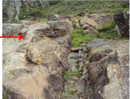
*Eje de Presa, planos de estratificación abiertos sin relleno (lecho quebrada y estribo derecho)*
