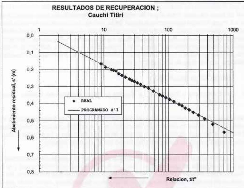
Figura 8 – Gráfico del resultado de la prueba de recuperación
