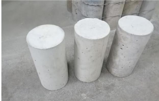
*Imagen 1 Probetas preparadas para rotura*
