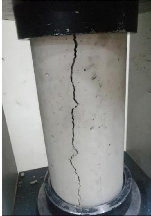
*Imagen 8 Fractura vertical en probeta*
