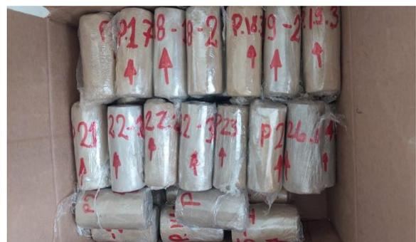
**Preparación de muestras (pastón o probeta) de arcilla**
