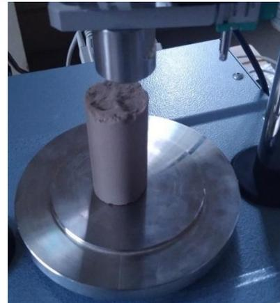
**Componentes del equipo automático para el ensayo de compresión no confinada**
