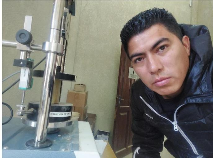
**Equipo automático para el ensayo de compresión no confinada**
