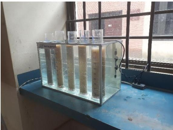
**Ensayo de hidrómetro**
