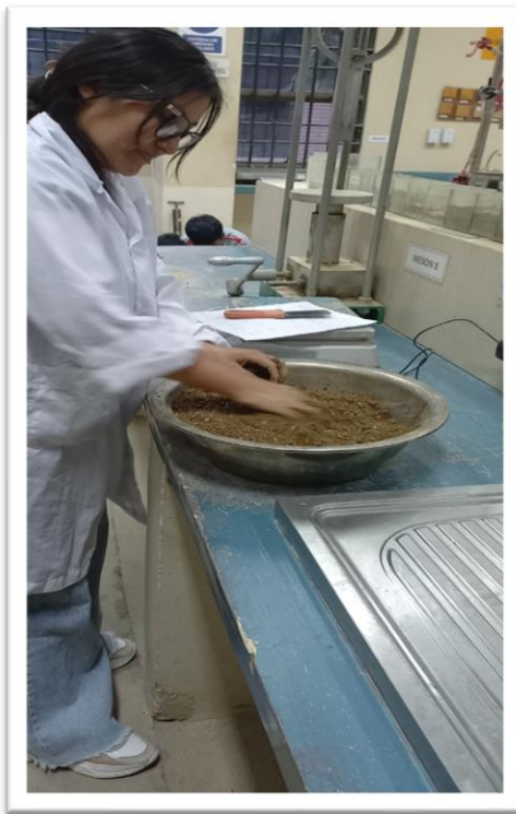
FOTOGRAFÍA 13. ENSAYO DE CBR (CALIFORNIA BEARING RATIO).
