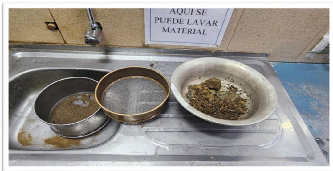
FOTOGRAFÍA 9. GRANULOMETRÍA MECÁNICA DE SUELOS.
