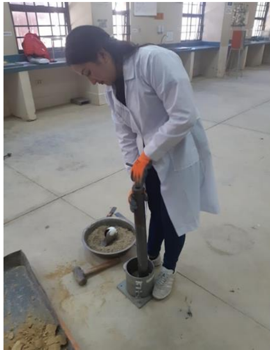
Realizando la compactación T-180 suelo natural
