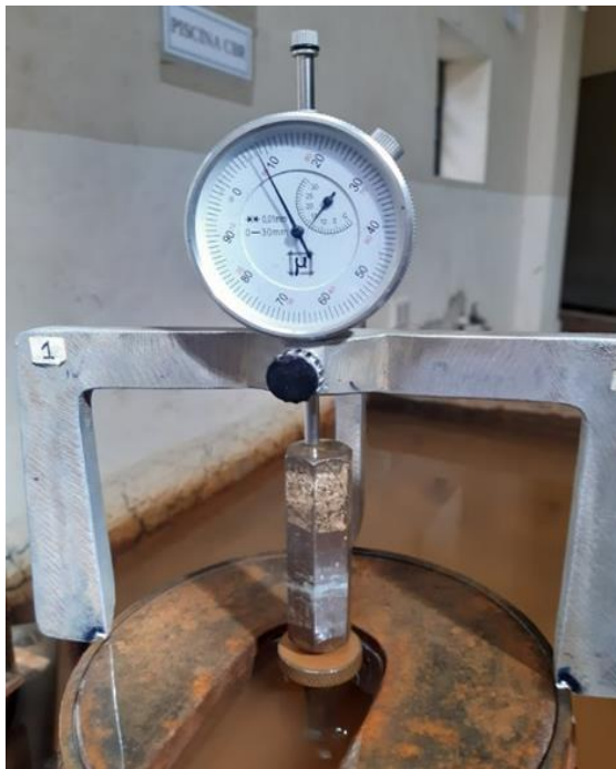
Lecturas del CBR con el extensómetro (Barrio San Blas)
