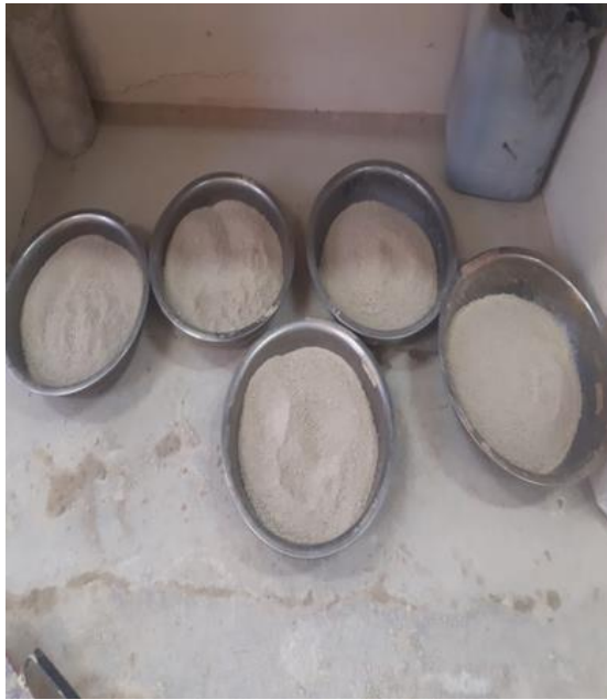
Preparando el suelo para la compactación T-180 Suelo natural (Barrio San Blas)
