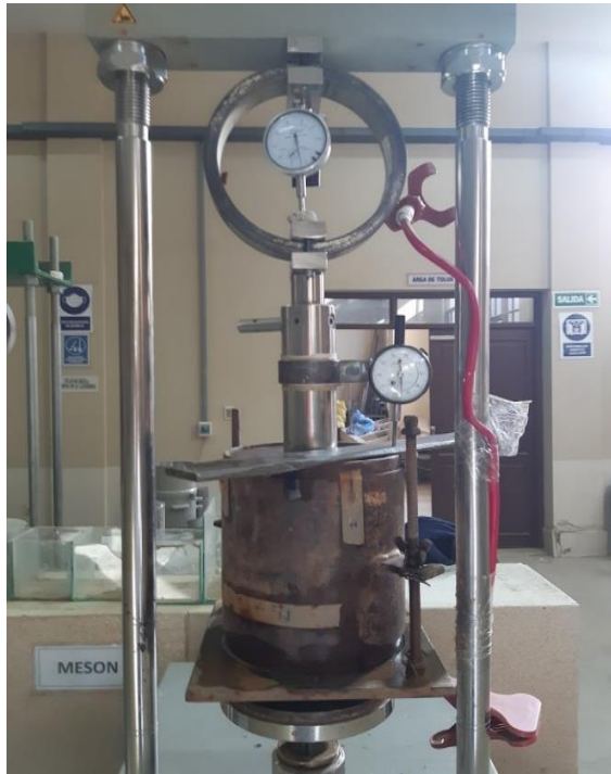
Haciendo correr el CBR en la prensa hidráulica Suelo más aditivo (Barrio jardín)
