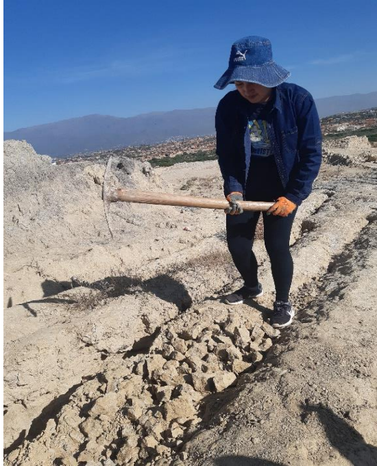
Extracción de la muestra del suelo natural CL
