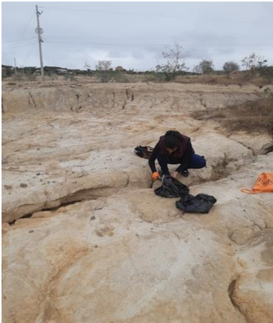
Extracción de la muestra del suelo natural CH (Barrio San Blas)
