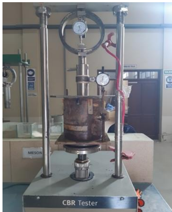
Haciendo correr el CBR en la prensa hidráulica Suelo más aditivo (Barrio San Blas)
