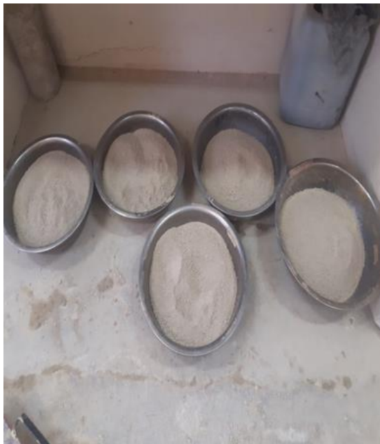
Preparando el suelo para la compactación T-180 Suelo natural (Barrio jardín)
