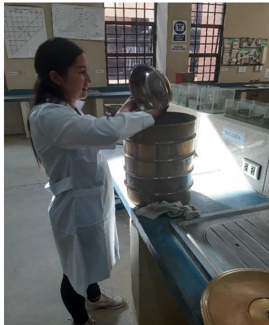
Tamizado del suelo después del lavado y secado (Barrio Jardín)
