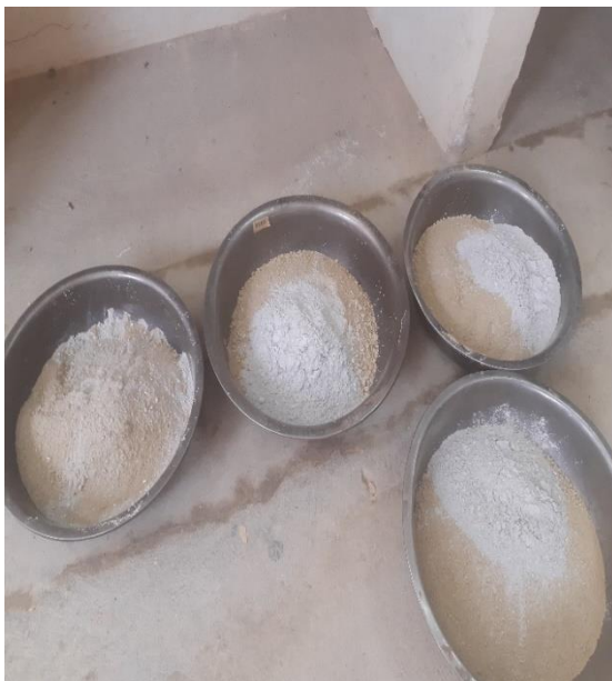
Aplicando aditivo Agrovial en porcentajes (5%, 10%,15%,20%) Para la compactación T-180 (Barrio jardín)
