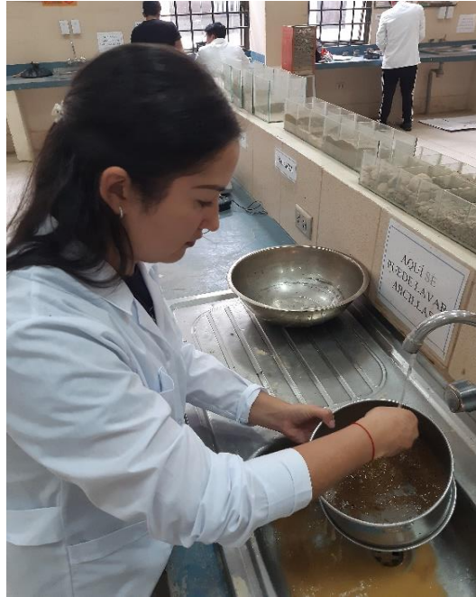
Clasificación del suelo (método del lavado) (suelo barrio jardín)
