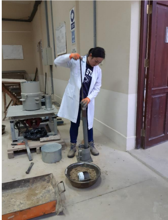
Realizando la compactación T-180 suelo natural (Barrio jardín)
