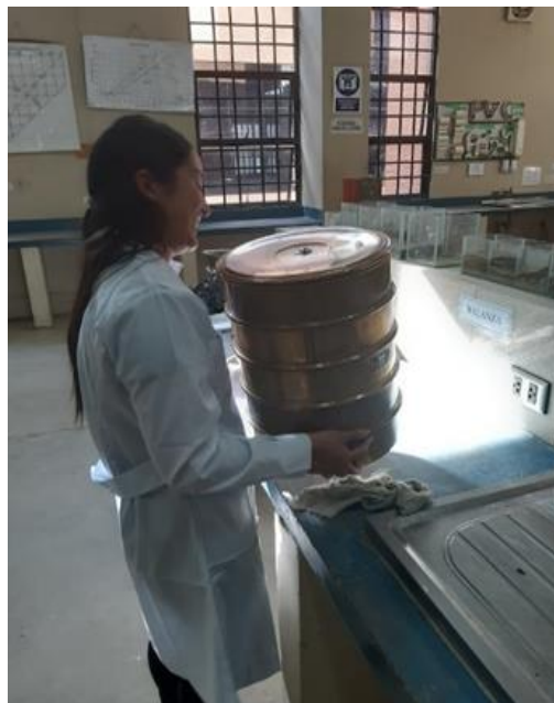
Tamizado del suelo después del lavado y secado (Barrio San Blas)
