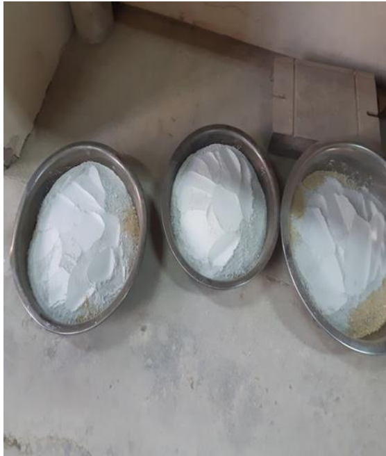
Aplicando aditivo Agrovial en porcentajes (5%, 10%,15%,20% ) Para el CBR (Barrio San Blas)
