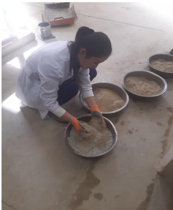
Preparando el suelo mezcla suelo más aditivo Agrovial Para la compactación (Barrio jardín)
