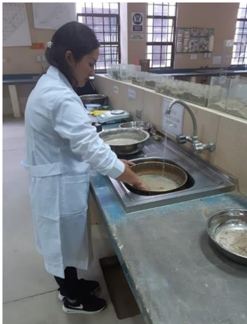
Clasificación del suelo (método del lavado) (suelo Barrio San Blas)
