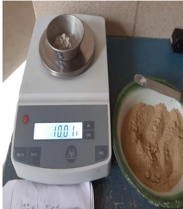
Límites de consistencia aplicando el aditivo agrovial (Barrio Jardín)
