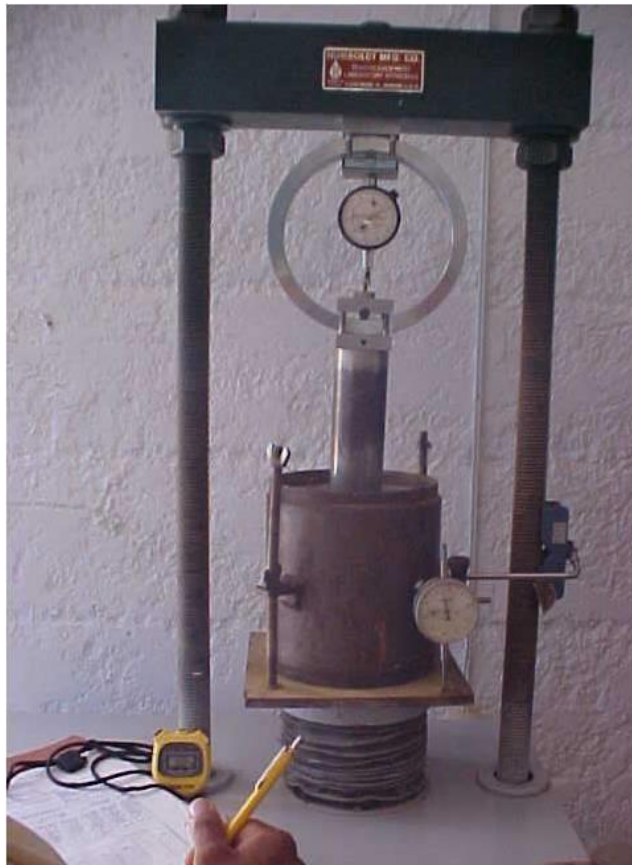
Ilustración 5: Prensa de compactación CBR
