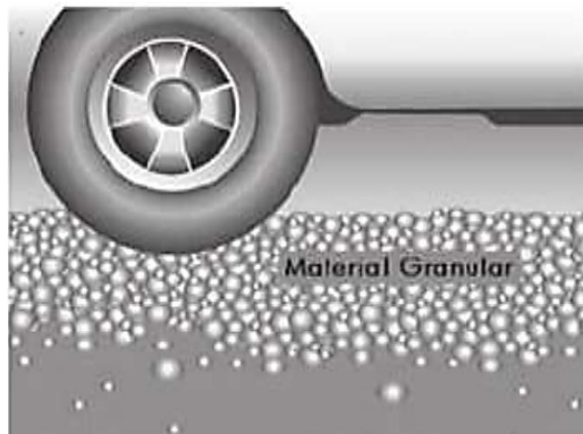
Ilustración 19: Perfil de terreno sin geosintético
