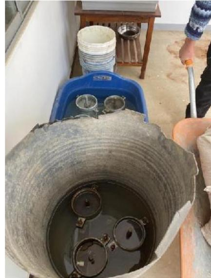
Probetas sumergidas en agua
