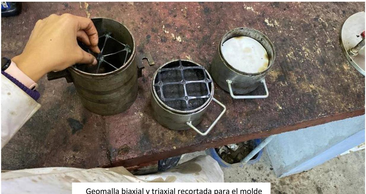
Geomalla biaxial y triaxial recortada para el molde
