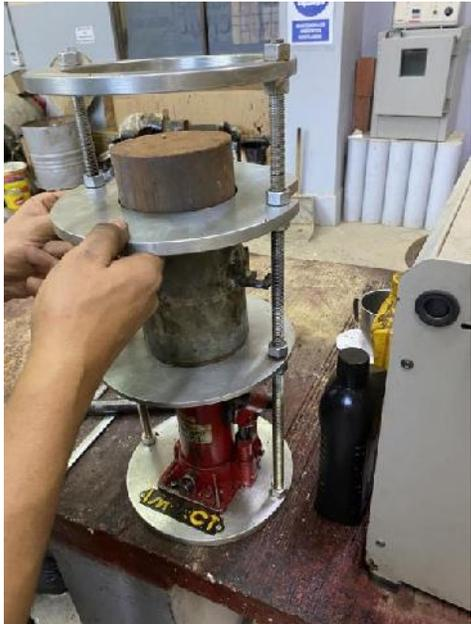
Desmolde de probetas
