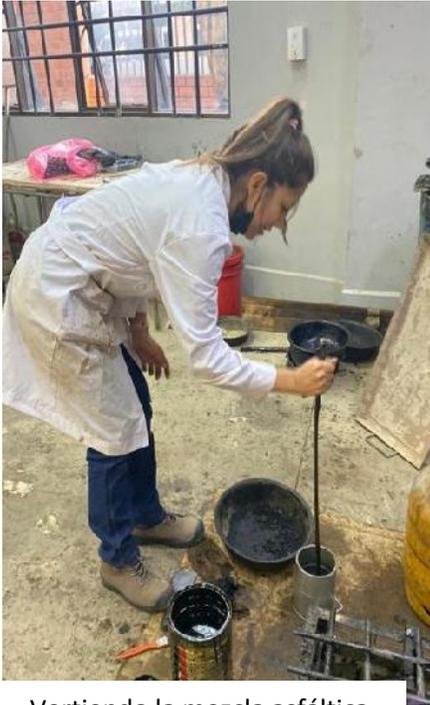
Vertiendo la mezcla asfáltica en los moldes y punzonando
