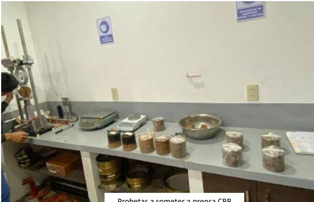
Probetas a someter a prensa CBR
