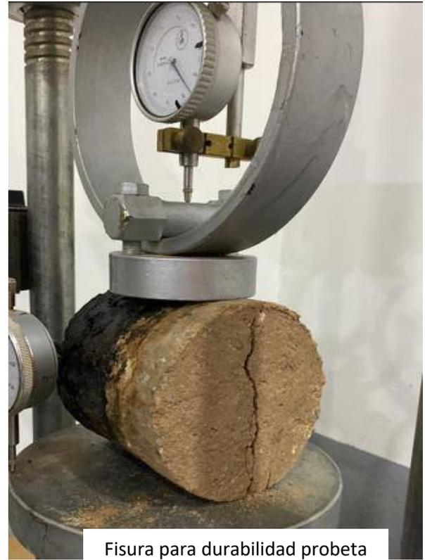
Fisura para durabilidad probeta rodadura base
