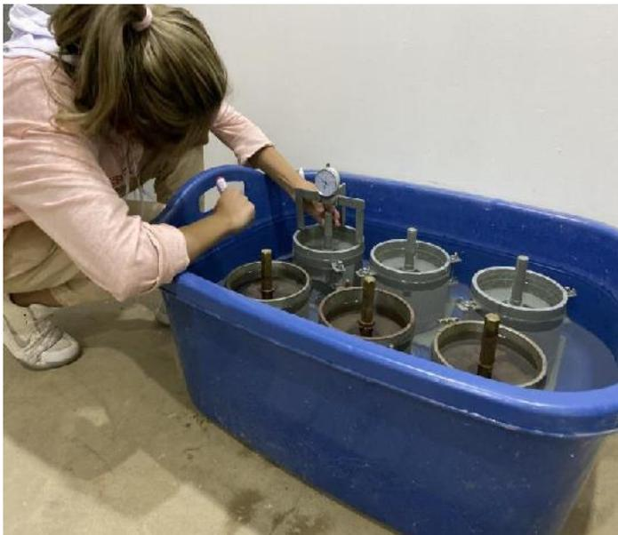
Lectura de probetas sumergidas
