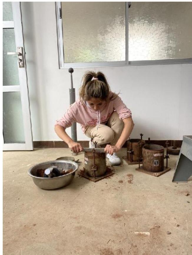
Enrazado de probeta
