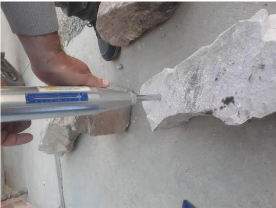
Ensayo de las muestras con el esclerómetro de cada roca.
