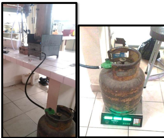
Ilustración 2-10 Generador y control de vapor (garrafa, cocinilla, balanza)
