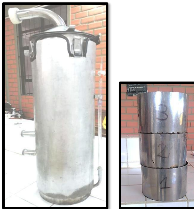
Ilustración 2-9 Torre de destilación y canastillos
