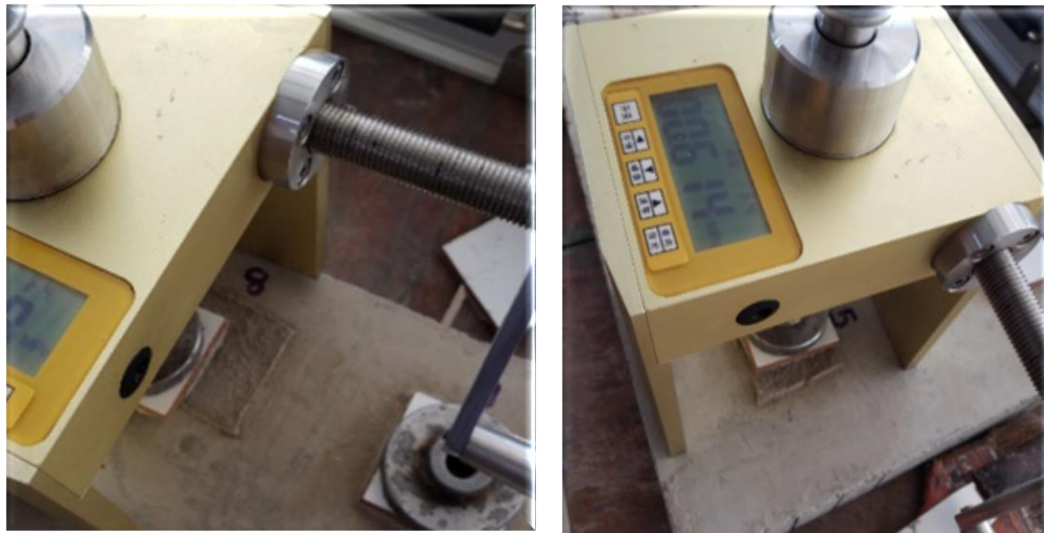
Figura 2-15 Rotura que realiza el Equipo de tracción
