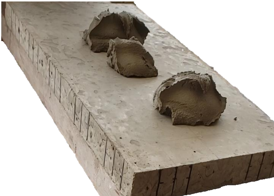
Fotografía 3-1 Mezcla en proporciones óptimas de cemento cola tipo C1
