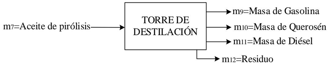
En la pirólisis se obtuvo 1725,08 kg de aceite de pirólisis con una densidad de 820 kg/m<sup>3</sup>, haciendo un volumen de aceite de pirólisis de 2,10376 m<sup>3</sup>.
