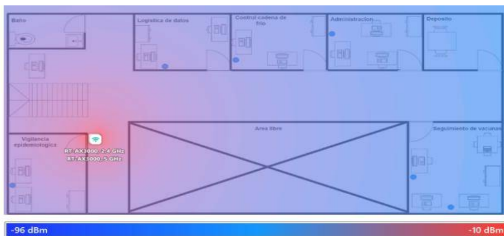
Figura 40. Nivel de señal en PAI primera planta
