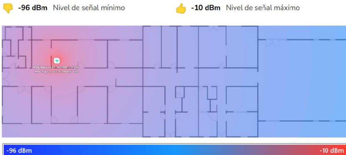
Figura 37. Nivel de señal actual del Access Point en SEDES
