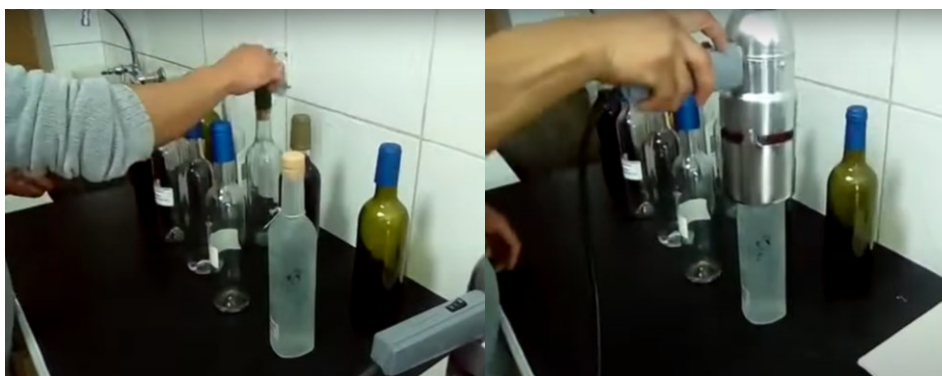
Figura VI-4 Funcionamiento de la Capsuladora
