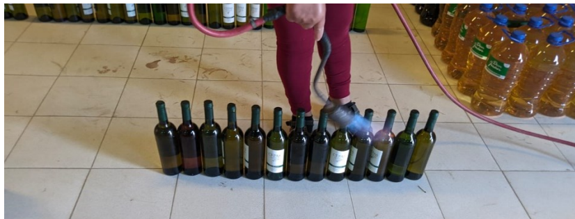
Figura IV-8 Adhesión de Cápsulas
