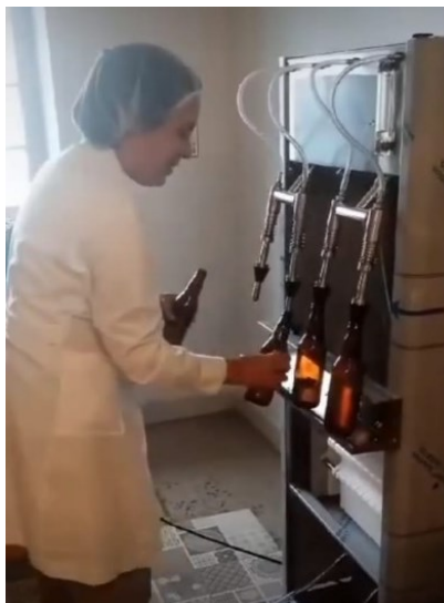
Figura VI-2 Funcionamiento de Llenadora
