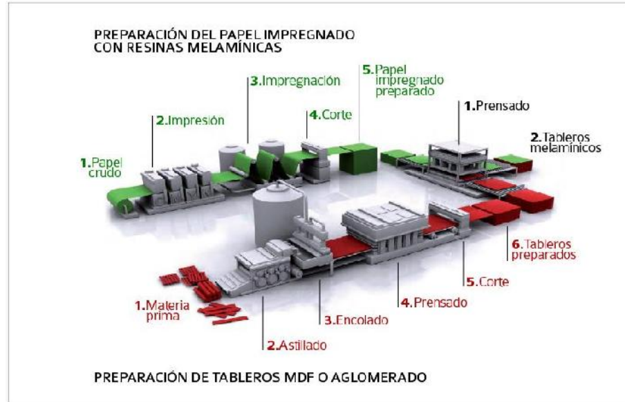
Ilustración 5 Proceso de producción de las maderas prefabricadas o (tableros melamínicos)
