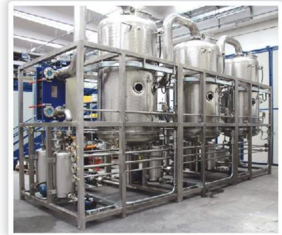
Ilustración 43 Evaporador Industrial de aguas residuales
