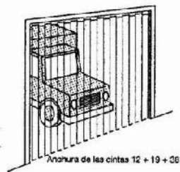
14 Cortina de cintas de PVC para el paso de grandes vehículos
