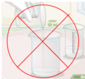
Adición del Agua a la Soda Caustica
