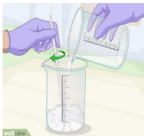
Adición de Soda Caustica al Agua
