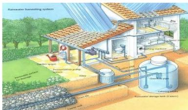
Captación de aguas pluviales utilizando la cubierta del edificio como captadores, cumpliendo con el proceso de instalación de canaletas y bajantes hasta finalmente acopiar en un depósito.
