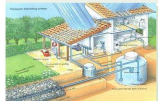
Captación de aguas pluviales utilizando la cubierta del edificio como captadores.
