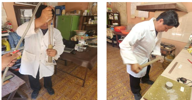
Figura 3.11: Equivalente de Arena y agitación del cilindro graduado con la muestra.
