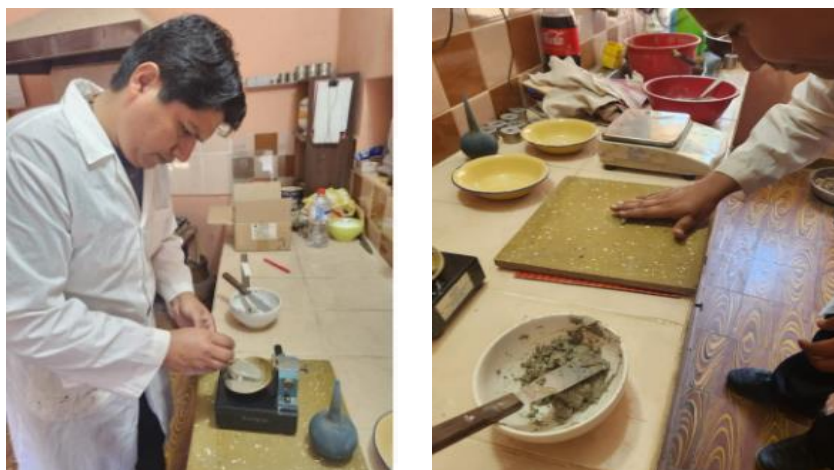
Figura 3.27: Colocado y retiro de la muestra en el aparato de casa grande.
