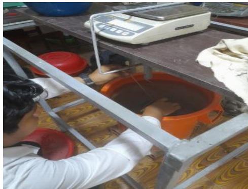
Figura 3.33: Briqueta sumergida en agua.
