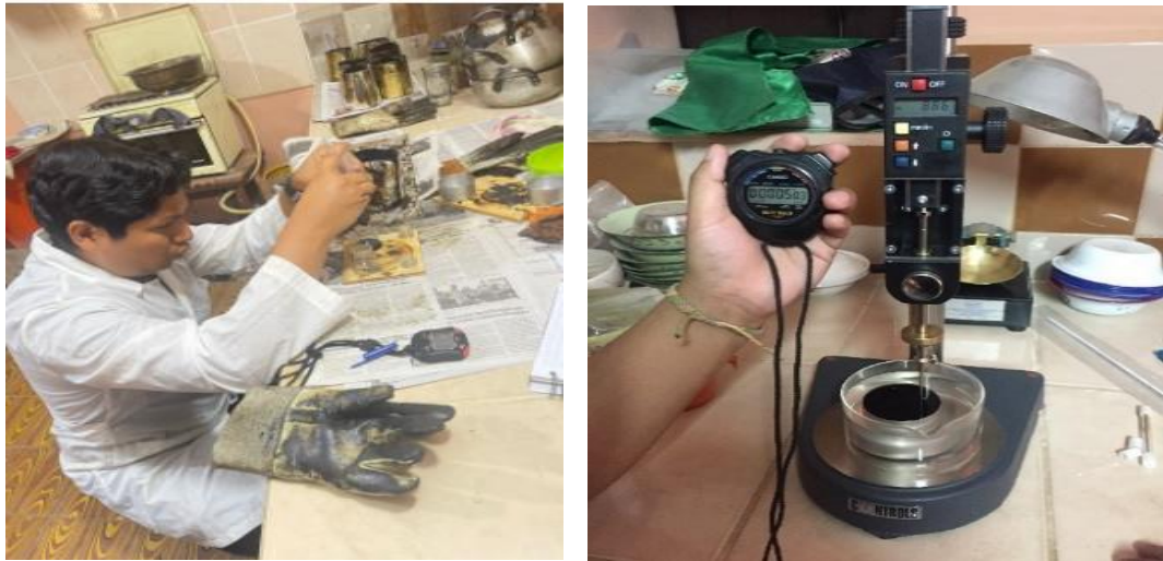
Figura 3.20: Realización del ensayo de penetración del cemento asfáltico.
