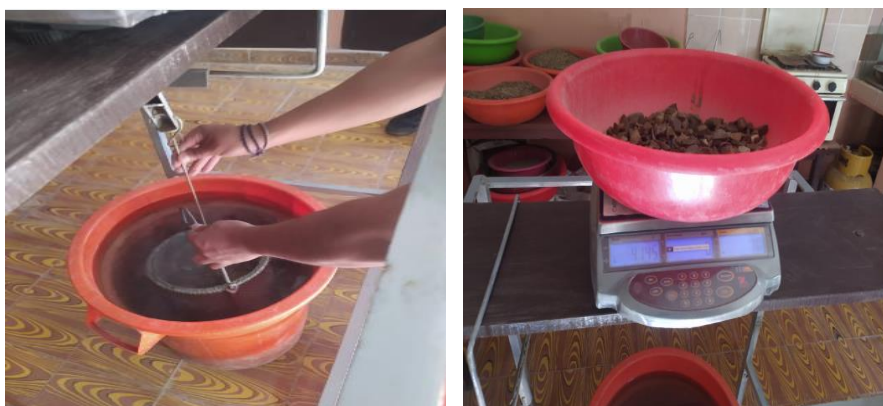
Figura 3.8: Obtención del peso sumergido en agua.
