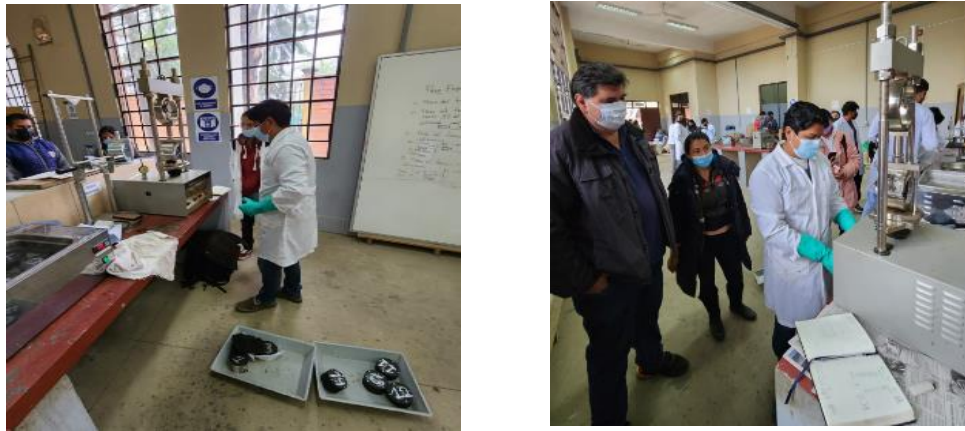
Figura 3.34: Ensayo de Estabilidad y Fluencia.
