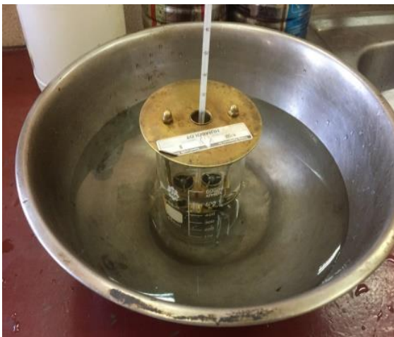
Figura 3.22: Ensayo punto de ablandamiento.
