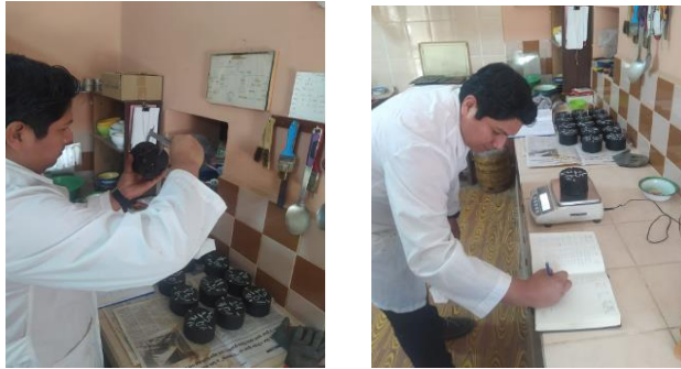
Figura 3.32: Medición de las alturas de la briqueta.
