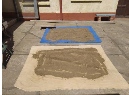
Figura 3.9: Secado superficial del material.
