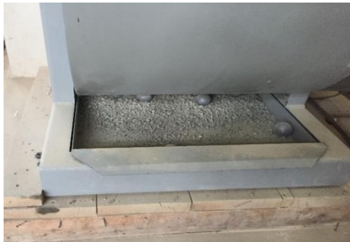
Figura 3.13: Máquina de desgaste por abrasión y material ensayado.
