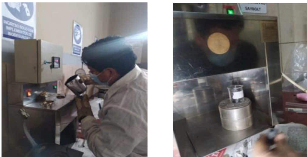
Figura 3.24: Realización del ensayo de viscosidad de Saybolt-Furol.
