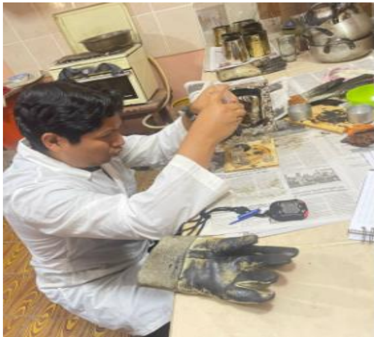
Figura 3.21: Realización del ensayo peso específico del cemento asfáltico.
