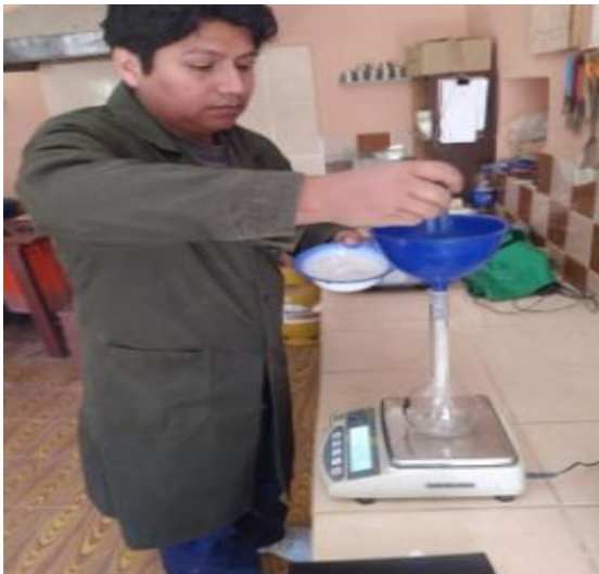
Figura 3.29: proceso de lavado del filler.
