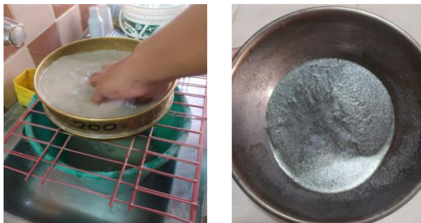
Figura 3.28: proceso de lavado del filler.
