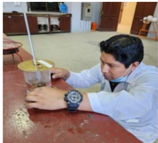
Figura 3.22: Ensayo punto de ablandamiento.
