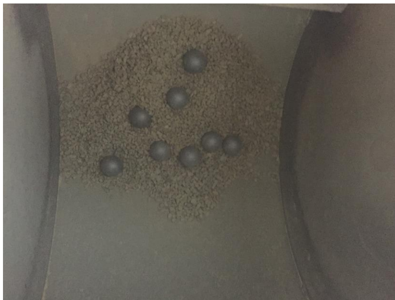
Figura 3.15: Agregado grueso – gravilla y las 8 esferas.
