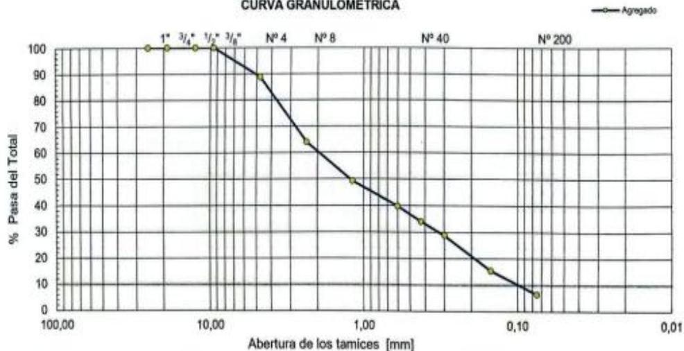
**OBSERVACIONES.**- Agregados triturados. La toma de la muestra ha sido ejecutado por mi persona, y llevada a laboratorio para la ejecución de ensayo. Norma de referencia según lo establecido en la sección 5.11.2.1 ETG 2-11 Carpeta de concreto asfáltico mezclado en caliente de las Especificaciones Técnicas Generales.
