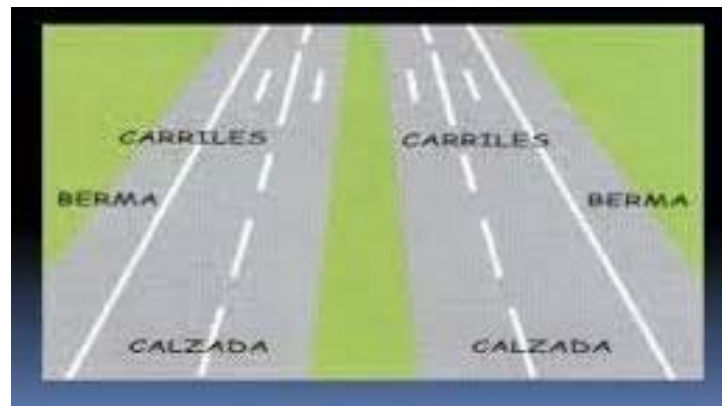
figura 4 Vías de pavimento
